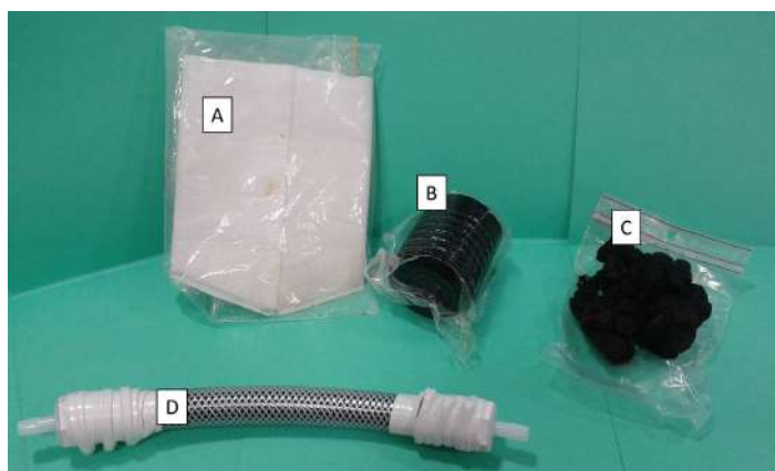
FIGURE 4.1 – Filtre à particules (A), cartouche Mn (B), fibre Mn (C) et cartouche PVC contenant une fibre Mn (D) pour la filtration de petit volume d'eau (à partir de 10L) pour l'analyse du ^{226}Ra .
