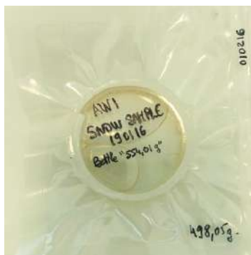
FIGURE 7.2 – Échantillon d'eau (neige) analysé par spectrométrie gamma (géométrie «small»)
