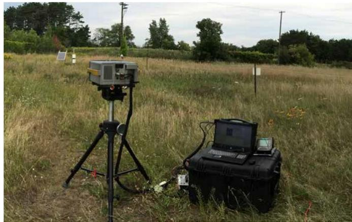
Fig. I.4: Hyper-Cam Methane de chez TELOPS
