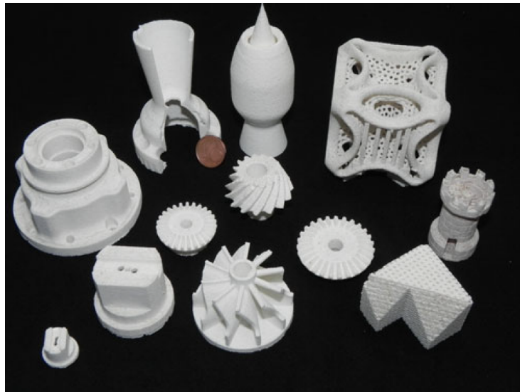
Figure 1.12 – Exemple de pièces en alumine réalisées par Laser Beam Melting , [20]
