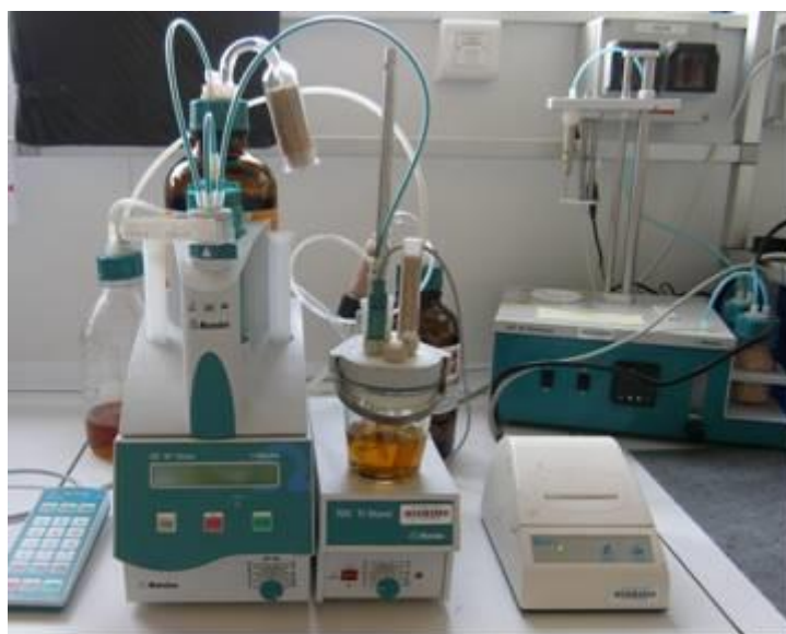
Figure 82 : Photographie des deux appareils du titrateur Karl-Fisher « 787 KF titrino » et « 703 Ti Stand »
