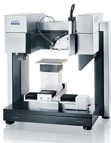
Figure 80 : Photographie de l'appareil de mesure d'angle de contact « Drop Shape Analyzer – DSA 100 »
