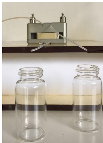
Figure 101 : Photo montrant la bonne configuration à prendre pour une utilisation correcte du dispositif de séparation membranaire Dolomite
