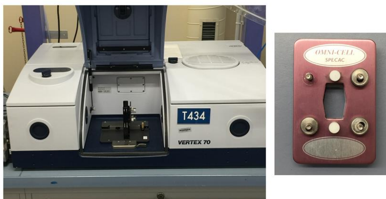
Figure 67 : Photographies du spectromètre Infra-Rouge « Vertex 70 » (à gauche) et de la cellule OMNI-CELL SPECAC (à droite)
