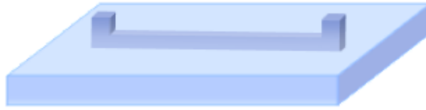
Figure 55 : Schéma d'un contre-timbre en PDMS
