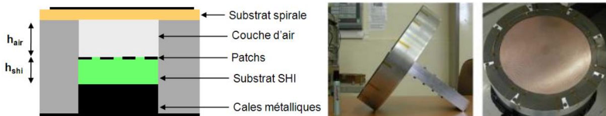
Figure 0-5: Schéma en coupe de la spirale sur cavité à méta-matériaux et photographie [52]
