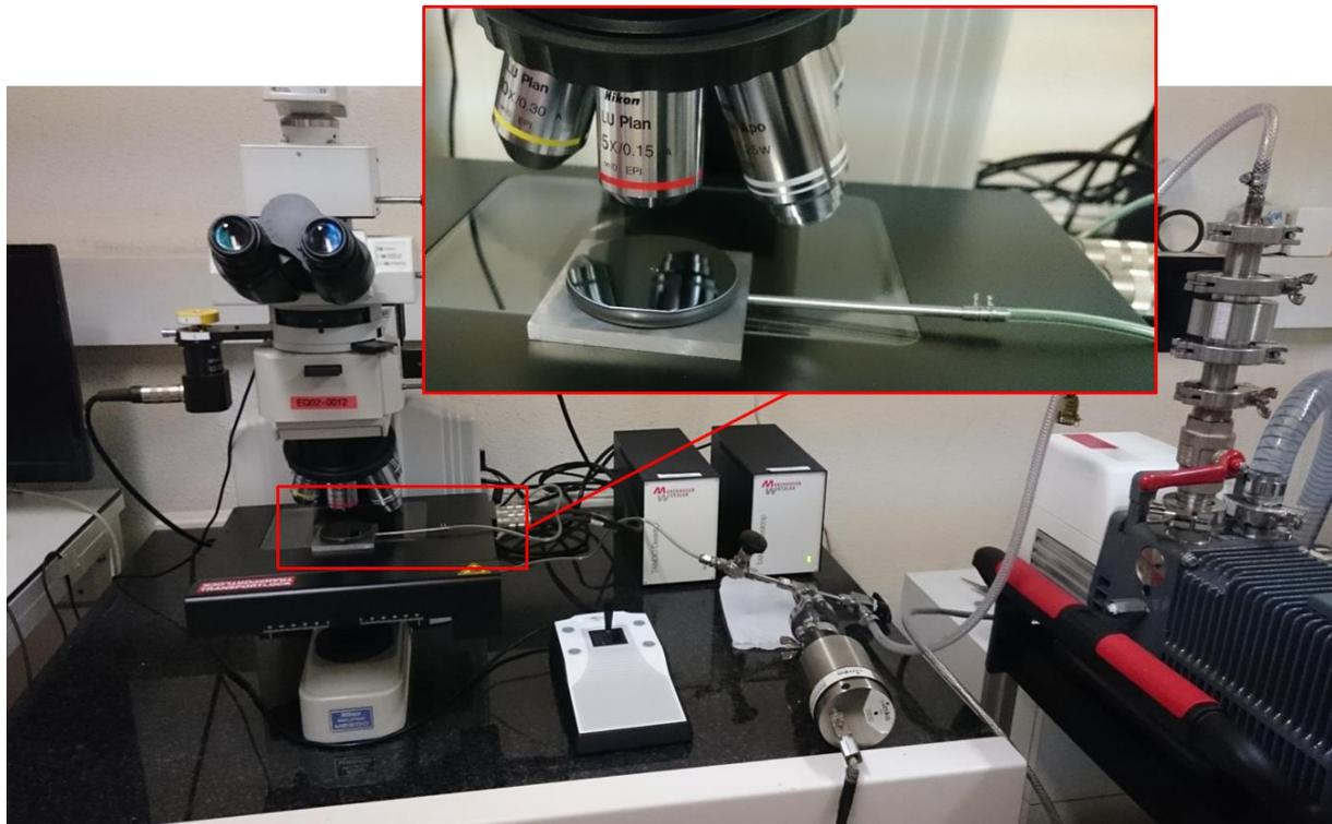
Figure 24 : Photo du montage utilisé pour la calibration de la mesure de contraintes par spectroscopie Raman
