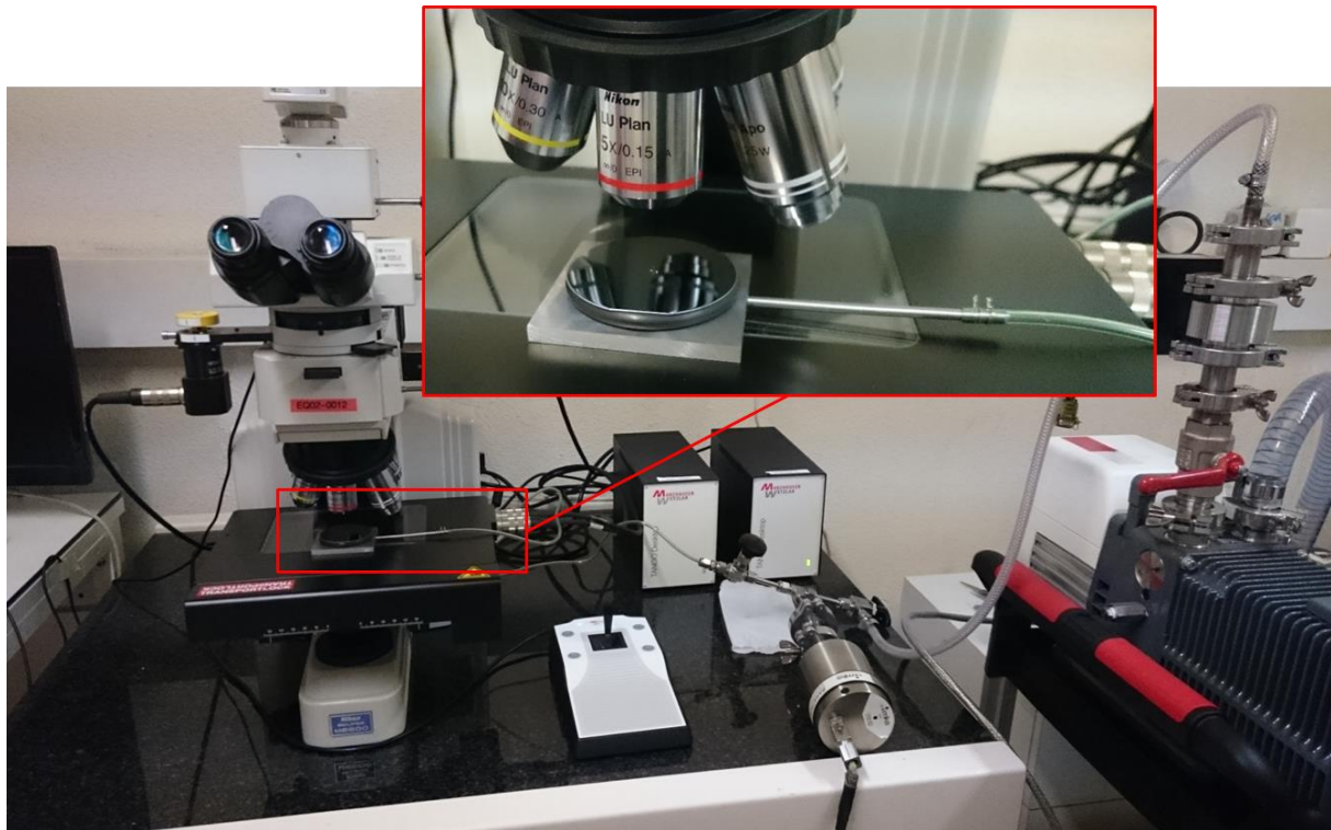
Figure 24 : Photo du montage utilisé pour la calibration de la mesure de contraintes par spectroscopie Raman
