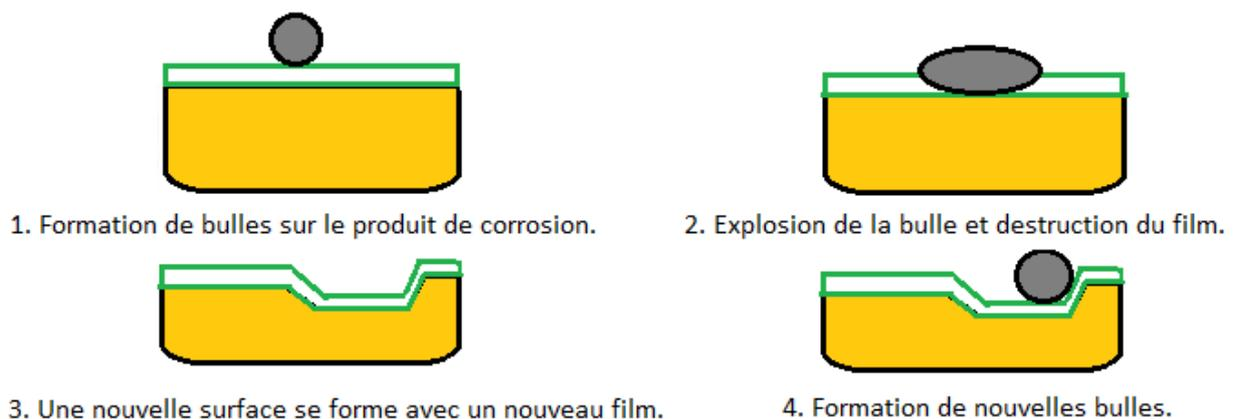
Figure I-7 : Cavitation-érosion du cuivre
