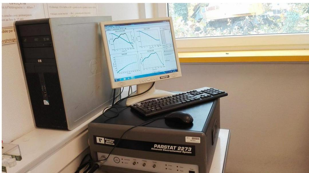
**Figure II-18 :** Montage de Spectroscopie d'Impédance Electrochimique (SIE) assisté par ordinateur utilisé pour le traçage des diagrammes d'impédance.
