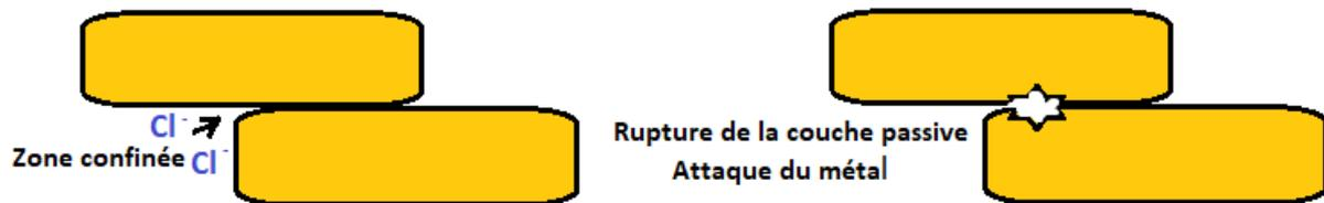
Figure I-5 : Corrosion caverneuse du cuivre.
