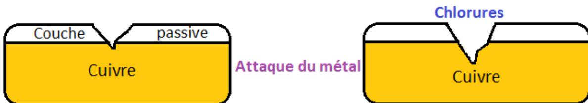
Figure I-4 : Corrosion du cuivre par piqûres.
