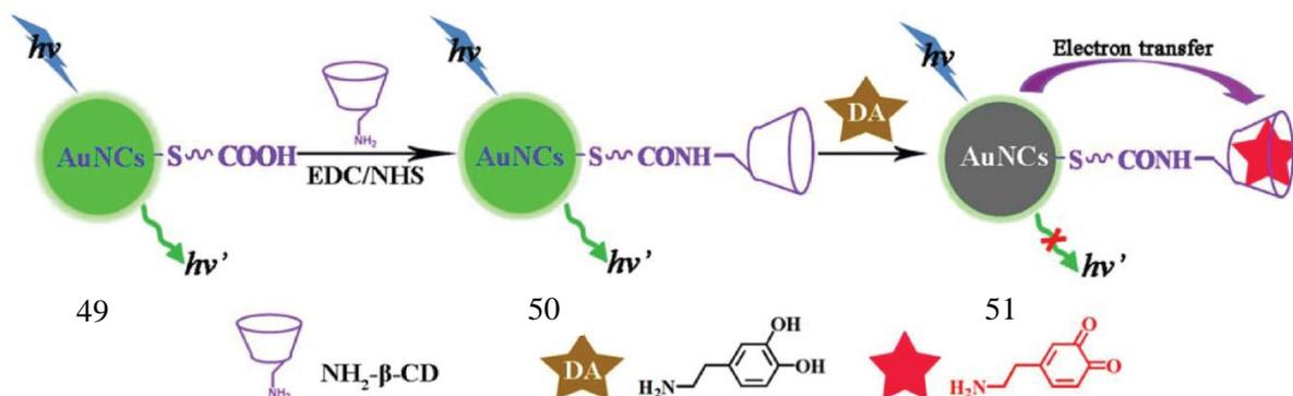
Figure 23: représentation du mécanisme de détection de la DA
