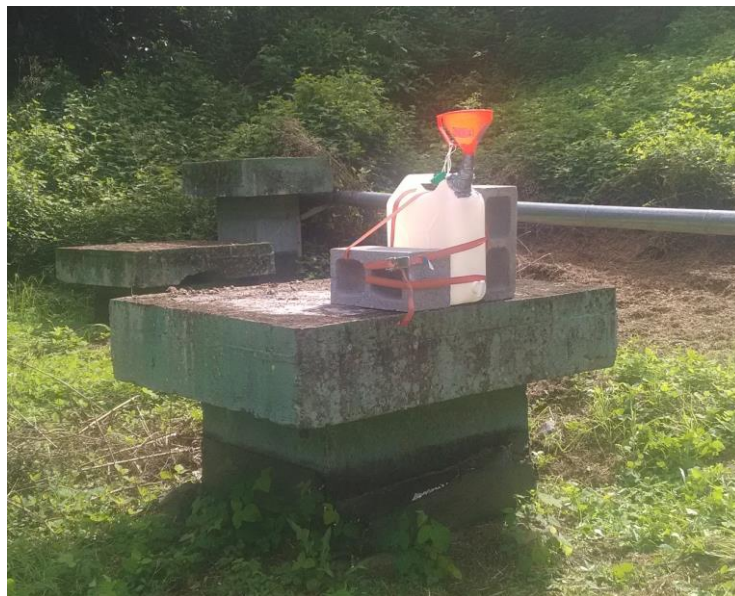
Figure 23 : Collecteur d'eaux de pluie installé à Cilaos près du bâtiment des nouvelles thermes.
