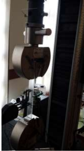
Figure II.12. Dispositif expérimental pour les essais de traction sur les éprouvettes de résine.
