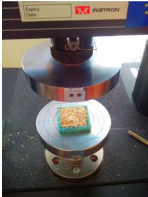
Figure II.16. Dispositif expérimental de compression des anas de lin en vrac.
