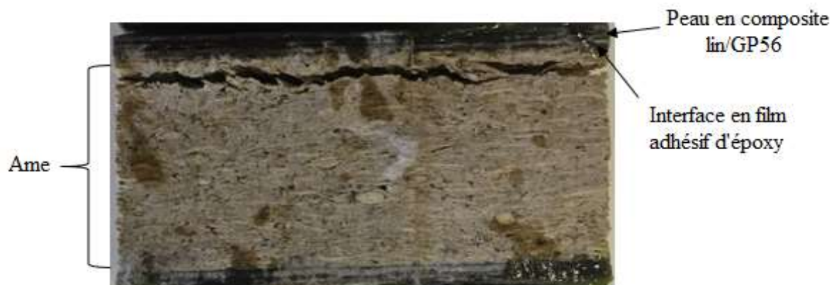
Figure IV.9. Rupture observée sur une structure sandwich élaborée par thermocompression et sollicitée en traction perpendiculaire.
