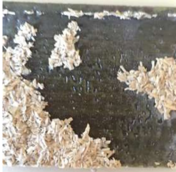
Figure IV.10. Faciès de rupture d'une structure sandwich élaborée par moulage sous vide.
