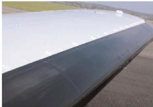
Figure 1-2. Boudins pneumatiques dégivrants en caoutchouc sur le bord d'attaque d'une aile [6].
