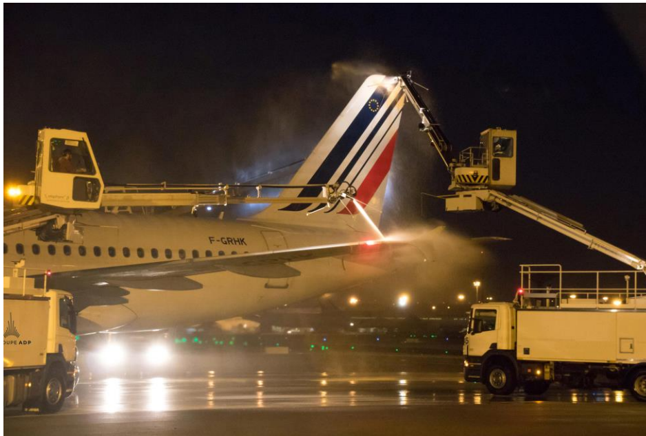
Figure 1-1. Application d'un fluide antigivrant [2].
