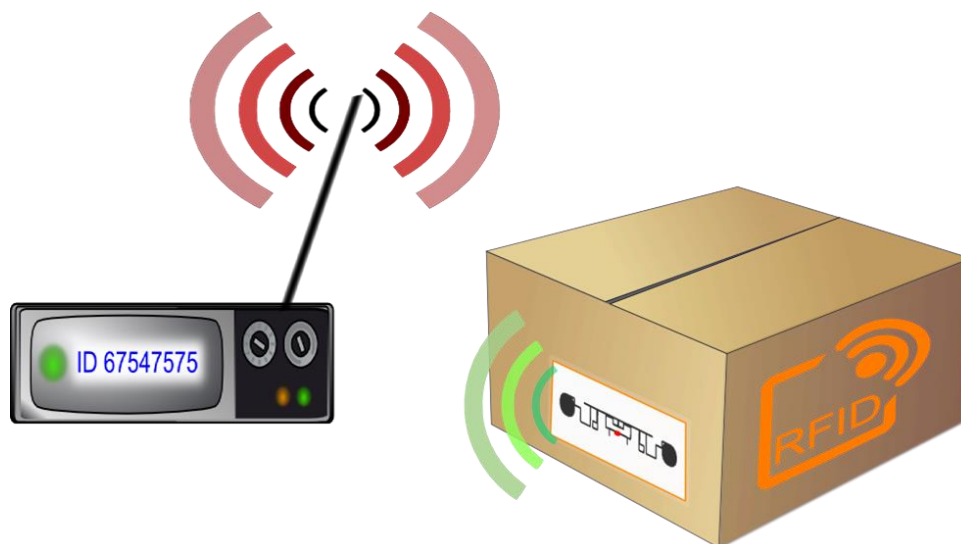
Figure 1.5 Présentation générale d'un système RFID. Le lecteur communique par un lien RF avec un tag. Le tag est composé d'une puce (point rouge) connectée à une antenne.
