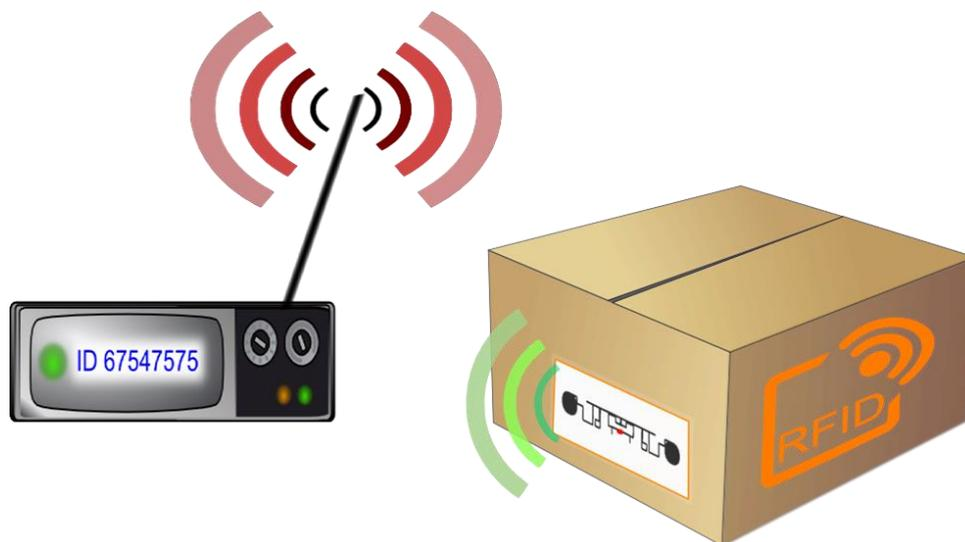
Figure 1.5 Présentation générale d'un système RFID. Le lecteur communique par un lien RF avec un tag. Le tag est composé d'une puce (point rouge) connectée à une antenne.
