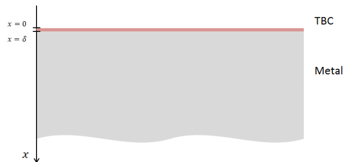
FIGURE C.1 – Représentation d'une plaque semi-infinie avec barrière thermique
