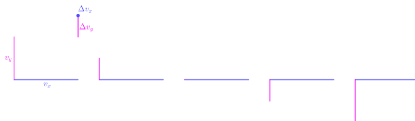
Figure 3-6 – Composantes horizontale et verticale du vecteur variation de vitesse et de cinq vecteurs vitesse tracés à intervalles de temps réguliers
