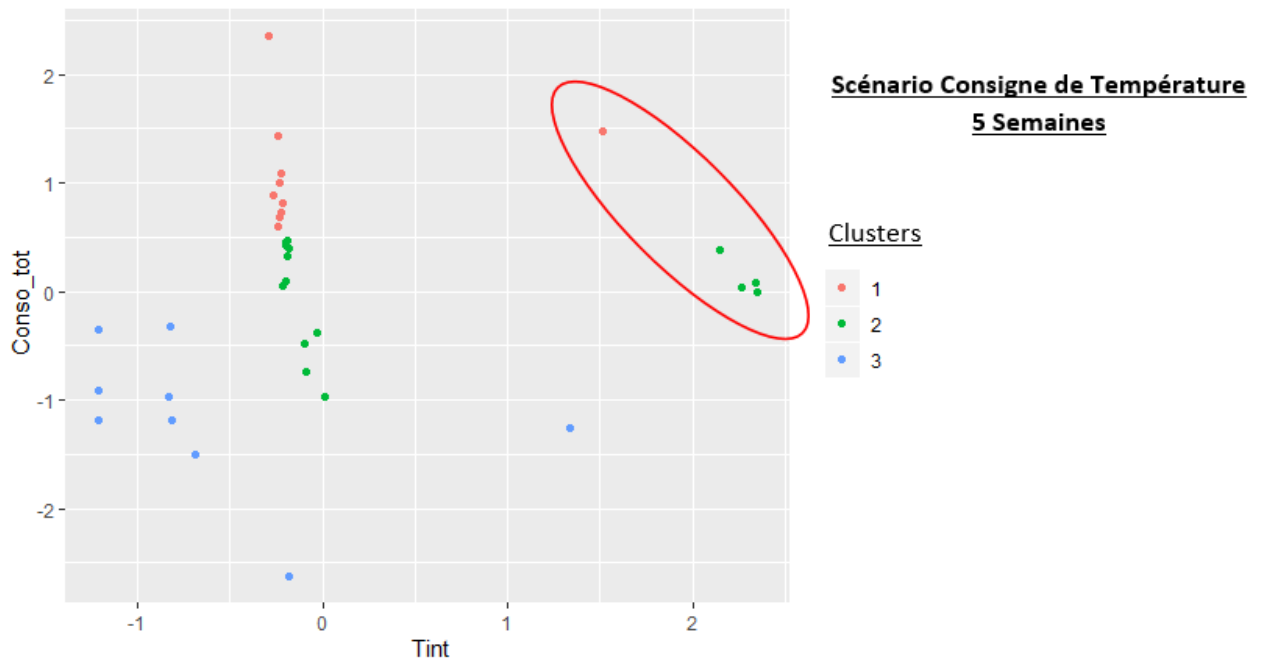
Figure 64 : Scénario Consigne de Température - Evolution de la température intérieure par cluster en fonction de la consommation (K=3)
