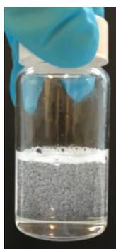
**Figure 3.15. Photographie d'une solution d'éicosane chauffée 3°C au-dessus de sa température de cristallisation après agitation manuelle : formation d'une mousse stable**
