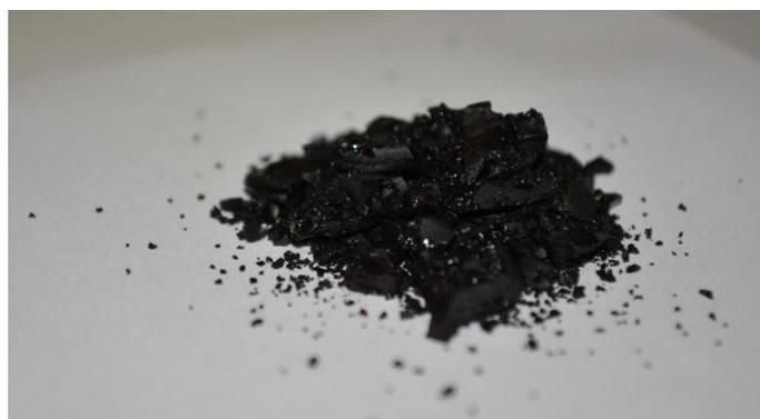
**Figure 1.4 Photographie d'asphaltènes issus du brut Tempa Rossa précipités dans l'heptane après séchage**
