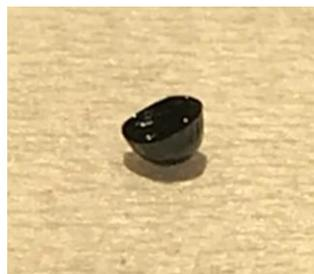
**Figure 4.5 Photographie de la peau d'asphaltènes formée après  $t=2500 s$ .**
