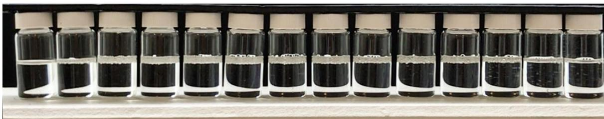
Figure 3.16. De gauche à droite : mélanges dodécane/toluène de 0 à 32,5 wt% en dodécane, par pas de 2,5 wt%, après agitation manuelle. Le maximum de moussabilité est atteint dans le 7<sup>e</sup> flacon
