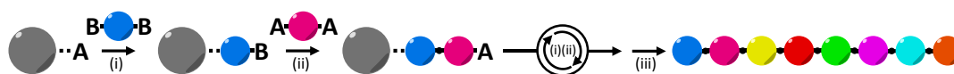
Figure I.23. Stratégie générale pour l'approche « AA+BB ». [10] (i) et (ii) Étapes de couplage. (iii) Étape de clivage.
