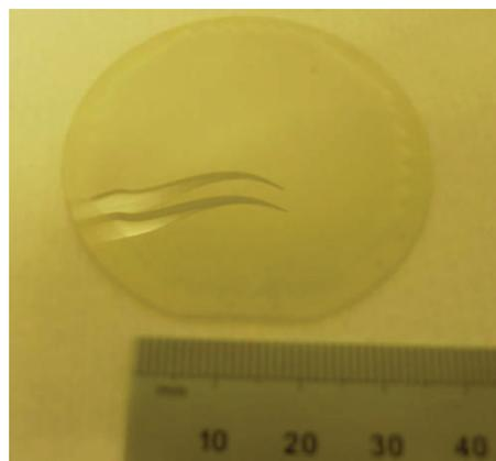
**Figure 14 : Photographie d'un pseudo-substrat  $(11\text{-}\bar{2}2)_{\text{GaN}}$  de diamètre 2 pouces réalisé par la méthode de croissance 3S-PSS. (La réflexion d'une pince brucelle est visible afin de mettre en évidence l'état de surface.)**
