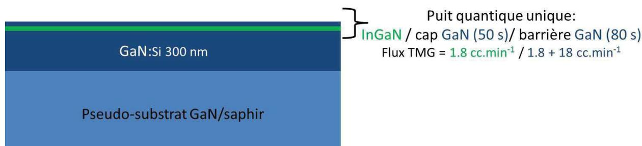
Figure VI:11 : Représentation schématique de l'hétérostructure étudiée (puits quantique unique). Les épaisseurs et températures (thermocouple) de référence sont indiquées. EPVOM utilisée : réacteur CCS 3x2'' Thomas Swann.
