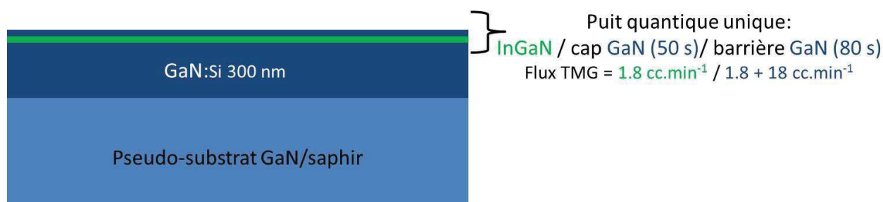
Figure VI:11 : Représentation schématique de l'hétérostructure étudiée (puits quantique unique). Les épaisseurs et températures (thermocouple) de référence sont indiquées. EPVOM utilisée : réacteur CCS 3x2'' Thomas Swann.
