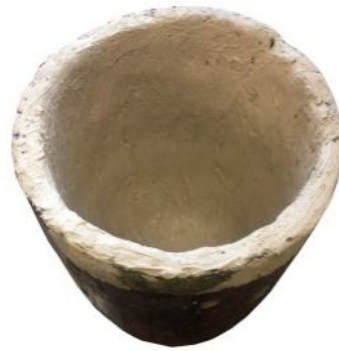
FIGURE 0-6 Creuset poteyé avec une couche de silicate de zirconium (CERAMOL 58/1)
