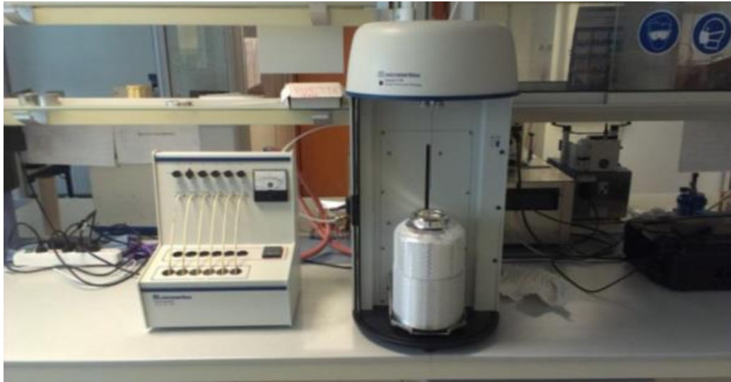
Figure 2.24. Appareillage pour la détermination de Surface Spécifique. Appareil de dégazage (à gauche) et l'analyseur (à droite)
