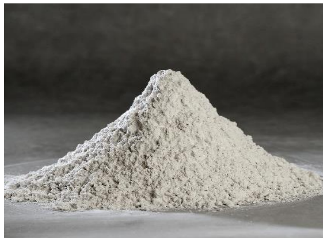
Figure 2.3. Laitier de haut fourneau moulu.
