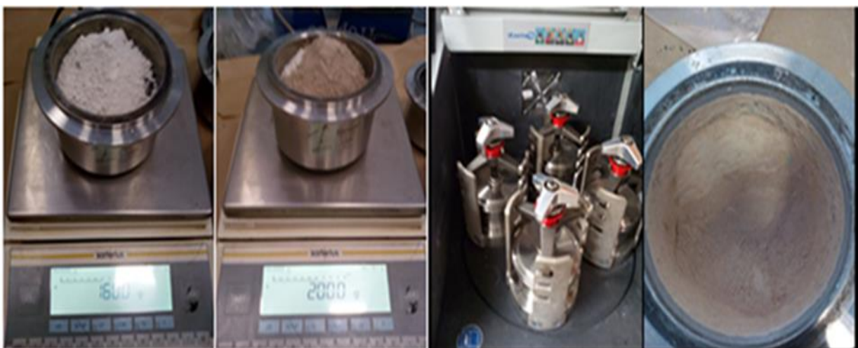
Figure 2. 15. Remplissage des jarres et résultats après broyage
