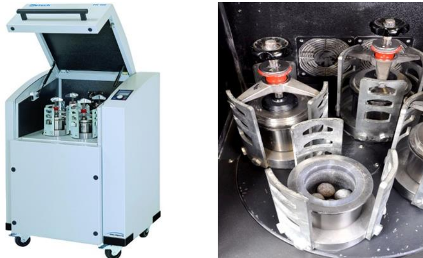
Figure 2.12. Broyeur planétaire PM 400 (A gauche) et son intérieur (à droite)
