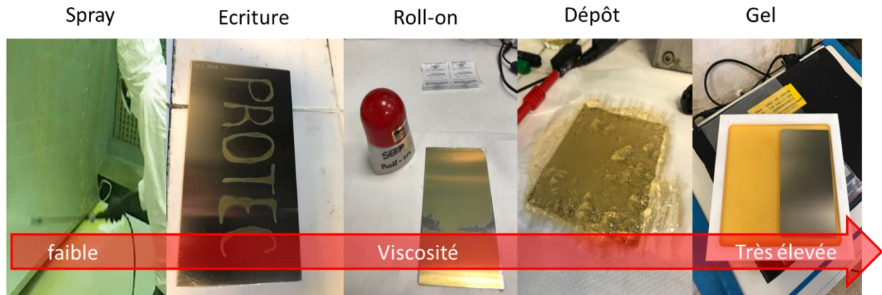
Figure 48: Techniques d'application possibles en fonction de la viscosité du gel
