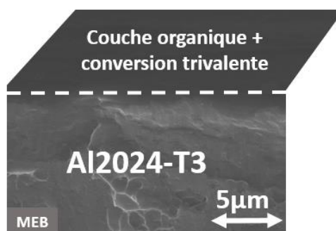
Figure 93: Image MEB en tranche de l'Al 2024 -T3 laminé greffé + conversion trivalente (Surtec 650)
