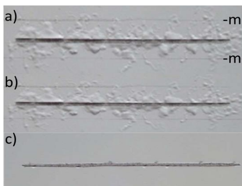
Figure 52: Echantillons ayant subis le test de corrosion filiforme a) Al2024-T3 b) Al2024-T3 après greffage du 4-nitrobenzènediazonium c) Al2024-T3 après traitement de conversion trivalente ou hexavalente
