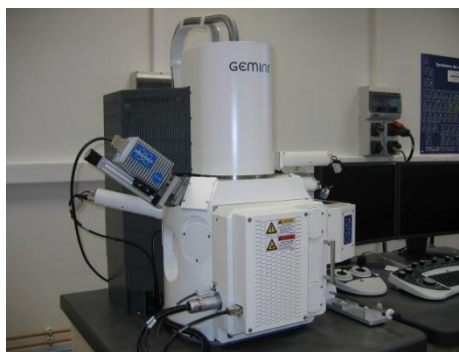
Figure 8: Microscope Electronique à Balayage couplé spectroscopie X à dispersion d'énergie (IRAMIS/NIMBE/LEDNA CEA Saclay)
