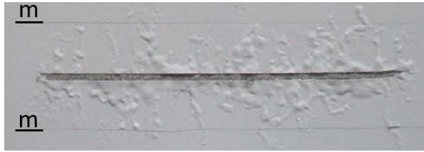
Figure 4: Illustration de la mesure de la longueur majoritaire m pour les tests de corrosion filiforme
