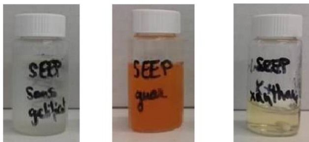
Figure 43: Allure des solutions après une semaine de conservation - de gauche à droite : Sans gélifiant, avec de la gomme de Guar et avec de la gomme de Xanthane
