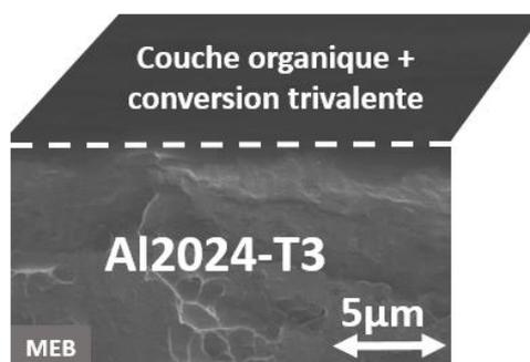
Figure 93: Image MEB en tranche de l'Al<sub>2024</sub>-T3 laminé greffé + conversion trivalente (Surtec 650)
