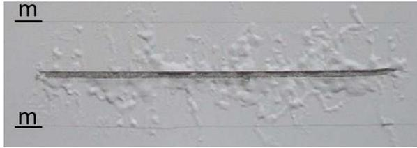
Figure 4: Illustration de la mesure de la longueur majoritaire  $m$  pour les tests de corrosion filiforme
