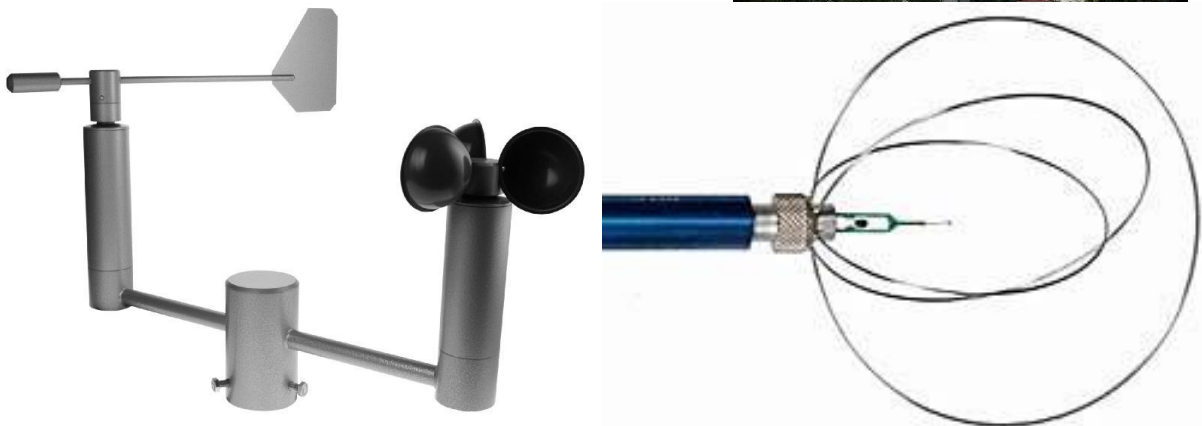
Figure 14 Anémomètre à coupelle et girouette en extérieur (à gauche), anémomètre à fil chaud en intérieur (à droite)
