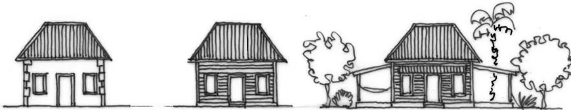
Figure 1- 5 : Evolution schématique d'une case créole réunionnaise : l'habitat tropical du modèle métropolitain (maison en maçonnerie et tuiles) à gauche, à son interprétation avec les matériaux locaux, le bois et la tôle (au milieu) et se « tropicalisation » avec ajout d'auvent, de varangue (à droite) (© auteur)
