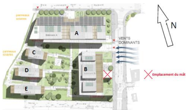
Figure 13 Localisation du mât de mesure
