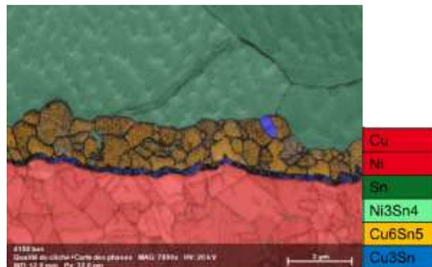
Figure 121 : Analyse EBSD sur échantillons de 2000 cycles, informations des phases du côté du substrat.
