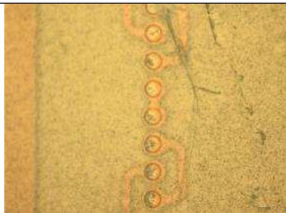
Figure 87 : Vue d'une partie faiblement brasée.
