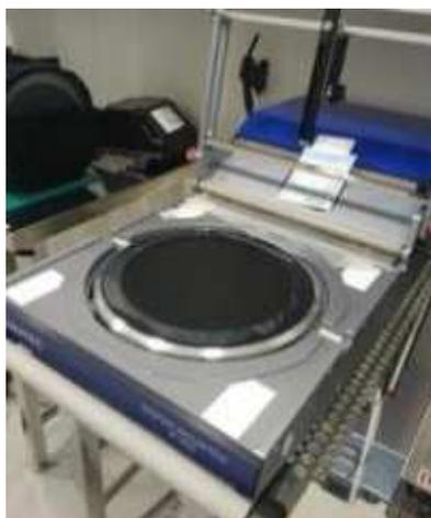
Figure 76 : Outil permettant de placer/enlever l'adhésif.
