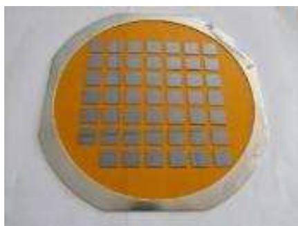
Figure 78 : Cadre + adhésif haute température.
