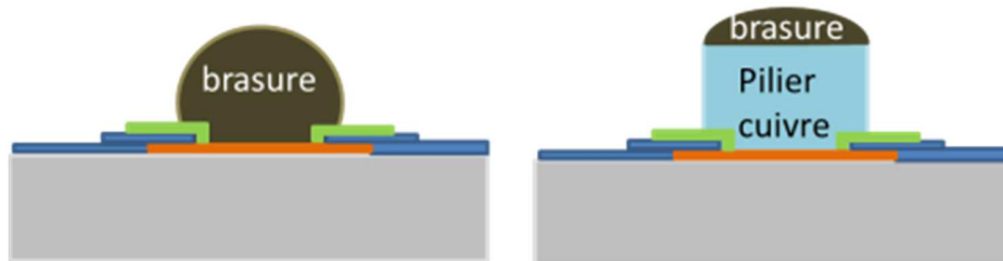
Figure 12 : Représentation d'une interconnexion par billage et par pilier de cuivre.
