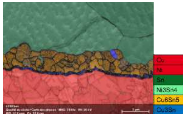
Figure 121 : Analyse EBSD sur échantillons de 2000 cycles, informations des phases du côté du substrat.
