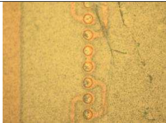
Figure 87 : Vue d'une partie faiblement brasée.
