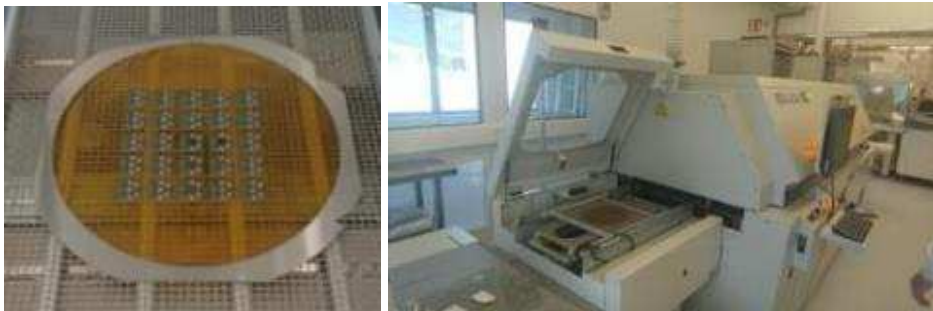
Figure 81 : Assemblage (puce + substrat), four Heller utilisé pour la refusion.
