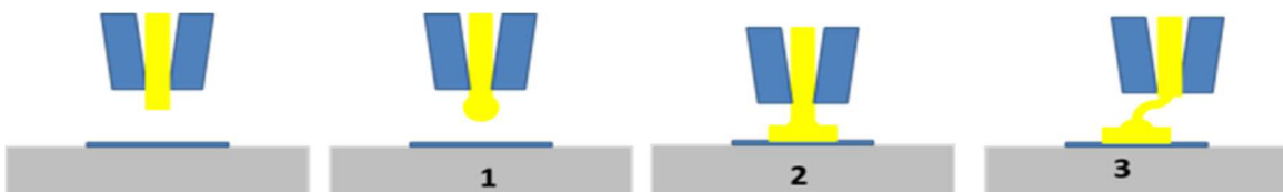
Figure 14 : Représentation des différentes étapes de dépôt des interconnexions pour un assemblage par billes d'or (GSB).
