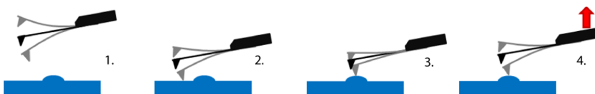
Figure 234 : Principe du mode oscillant. Schéma adapté Bruker®
