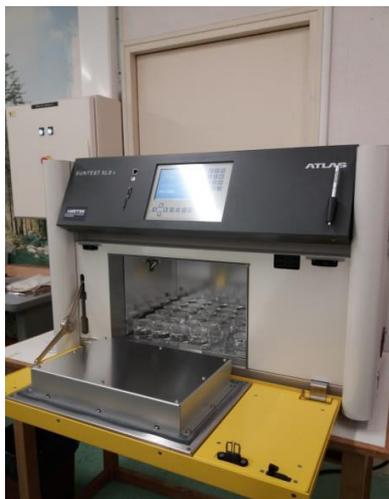
Figure 6 : Enceinte à vieillissement accéléré XLS+
