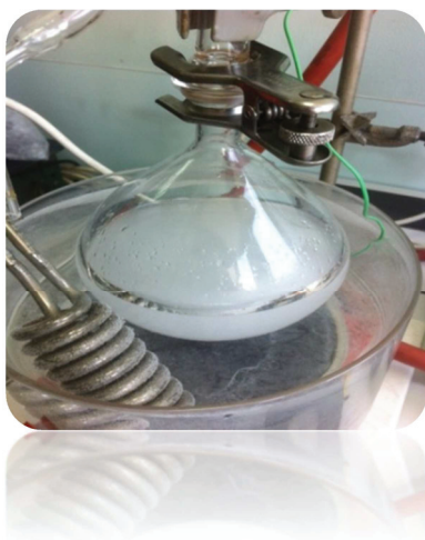
Figure II-50: Chauffage et agitation du mélange (1ChCl : 2 EG).
