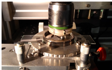
Figure IV.5 – Porte-échantillon adapté pour stabiliser l'échantillon, ici entre deux lamelles de microscopie. Une rondelle métallique vient s'ancrer dans la rondelle inférieure, l'échantillon restant entre les deux. Des demi-lames de verre peuvent aussi être positionnées sur les côtés des rondelles, maintenant la partie externe de l'échantillon.
