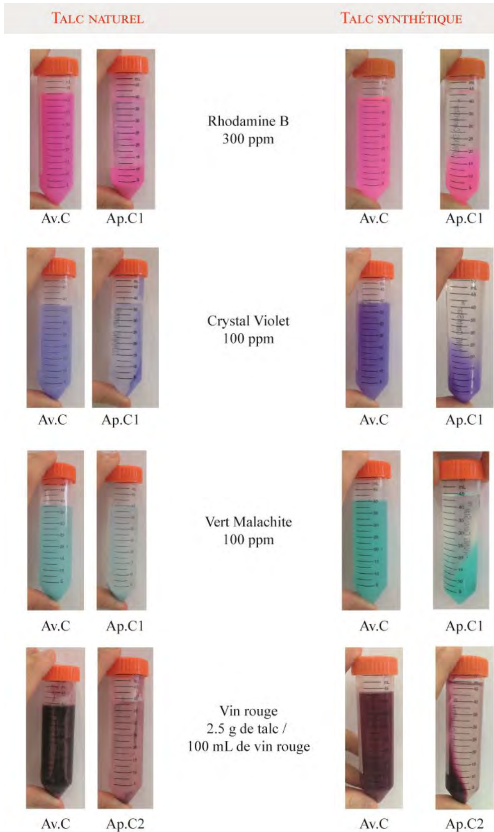
Figure 4 : Comparaison du pouvoir d'adsorption du talc naturel et synthétique vis-à-vis de différentes molécules organiques colorées et/ou fluorescentes (Av.C : Avant centrifugation ; Ap. C1 : Après une centrifugation ; Ap. C2 : Après deux centrifugations).
