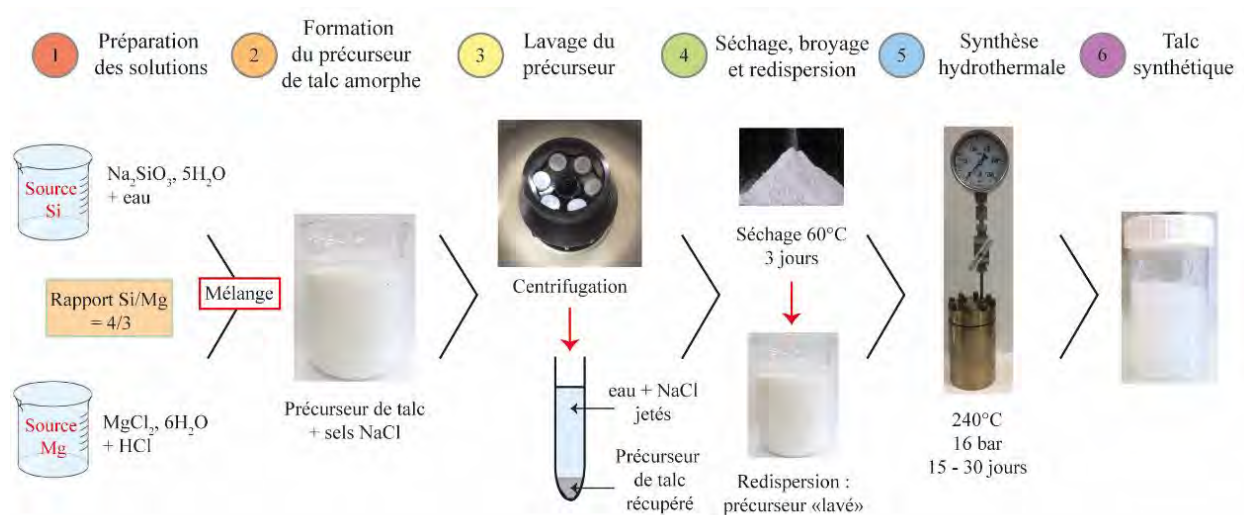
Figure 17 : Etapes de synthèse du protocole de Decarreau, 1989.
