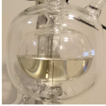
FIGURE 3.27 – Teinte jaune de l’ethanol observé au niveau du réservoir diphasique 10 jours après le remplissage
