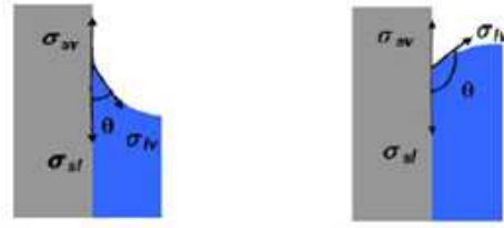
FIGURE 1.18 – Fluide mouillant ( \alpha < \pi/2 , gauche) et non-mouillant ( \alpha > \pi/2 , droite) au voisinage d'une paroi, reproduit depuis [50]
