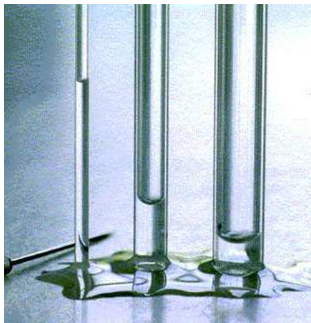
FIGURE 1.19 – Ménisques observés dans des tubes capillaires de différentes dimensions, reproduit depuis [49]
