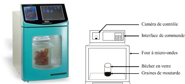
Figure II-3 - Appareillage utilisé pour chauffage micro-ondes (Générateur Milestone, f = 2.45 GHz)
