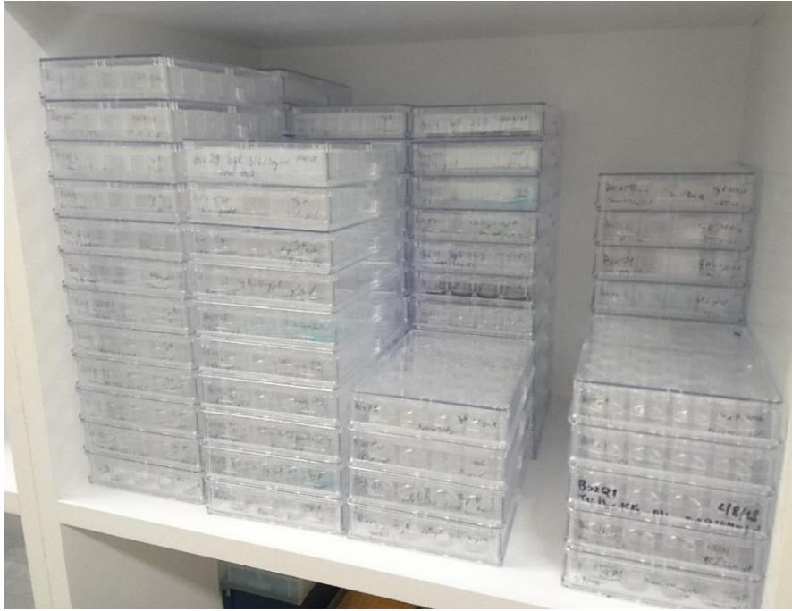
FIGURE 89 : Plaques de cristallisation 24 puits réalisées en chambre froide pour cristalliser la protéine TagR. Chaque puit contient 3 gouttes où TagR a été déposée à des concentrations différentes. Certaines plaques ont un reflet bleuté dû à l'ajout de cuivre dans la solution de cristallisation des puits.
