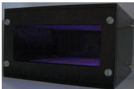
Figure 13 : Décharges plasma (en haut et en bas de la boîte) pour la décontamination rapide des mains par radiations UV/VUV [102].
