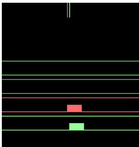
FIGURE 3.8 – Mode chronogramme : zoom sur les bits en collisions.
