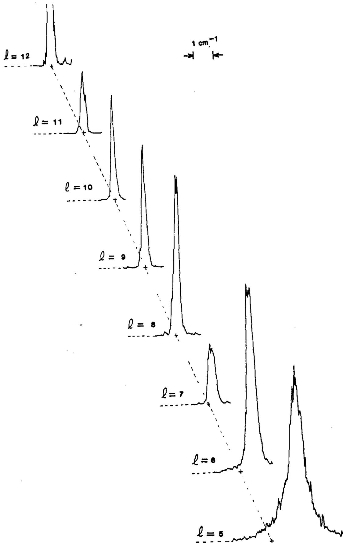
Figure IV.10 : Spectres d'excitation  $6s_{1/2}nl \rightarrow 6p_{1/2}nl$  du baryum pour  $n=13$  et  $l=5, 6, \dots, 12$ .
