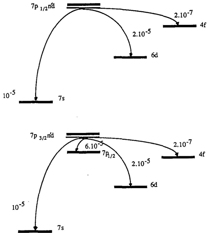
Figure II.4 : Schéma des voies d'autoionisation des séries 7pn'd
