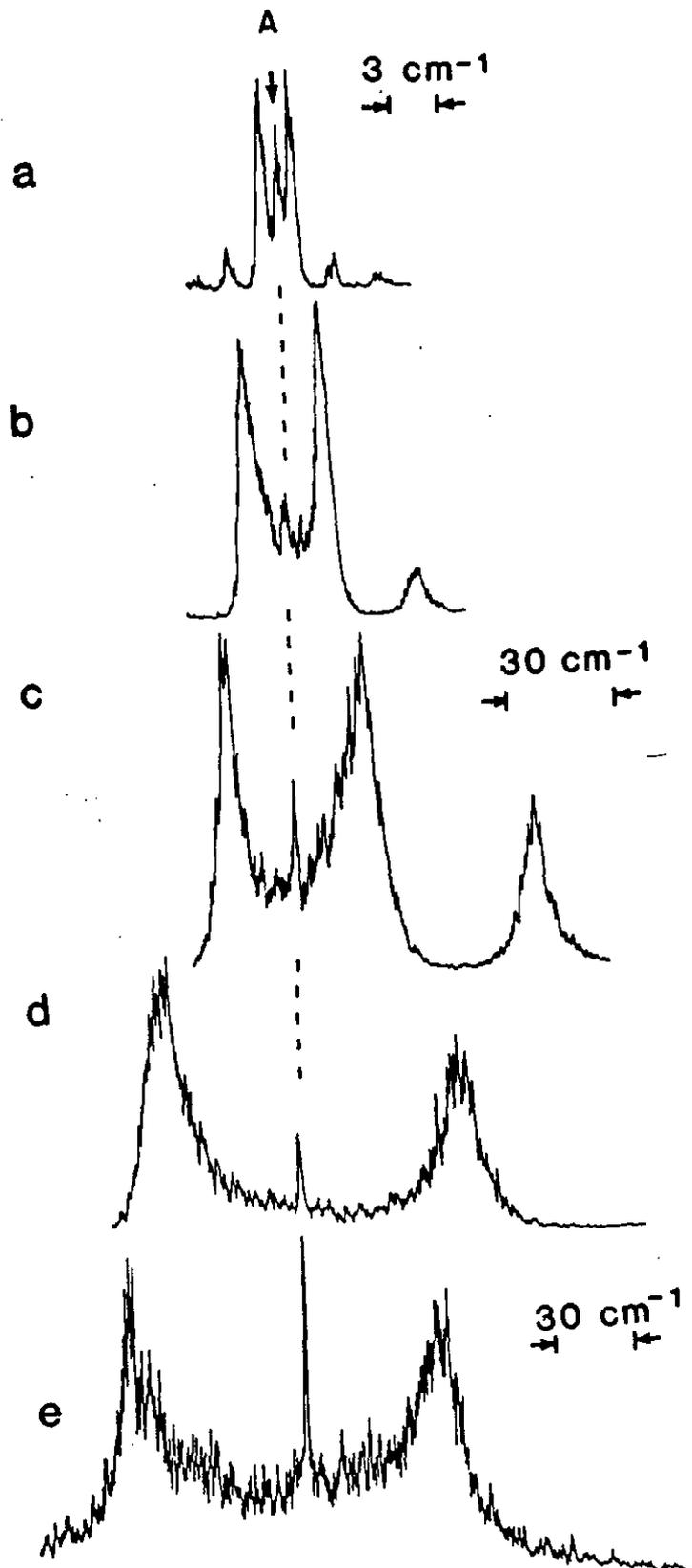
Figure II.13 : Spectres expérimentaux  $6s_{1/2}nd \rightarrow 7p_{1/2}n'd$  : (a)  $n=45$ , (b)  $n=35$ , (c)  $n=20$ , (d)  $n=16$  et (e)  $n=14$ . Raie ionique (A)  $\text{Ba}^+ 6s_{1/2} \rightarrow 7p_{1/2}$ .
