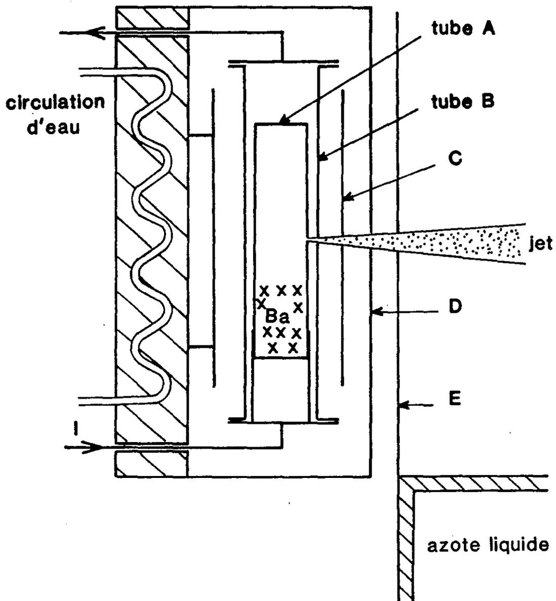
Figure II.7 : Schéma du four de baryum
