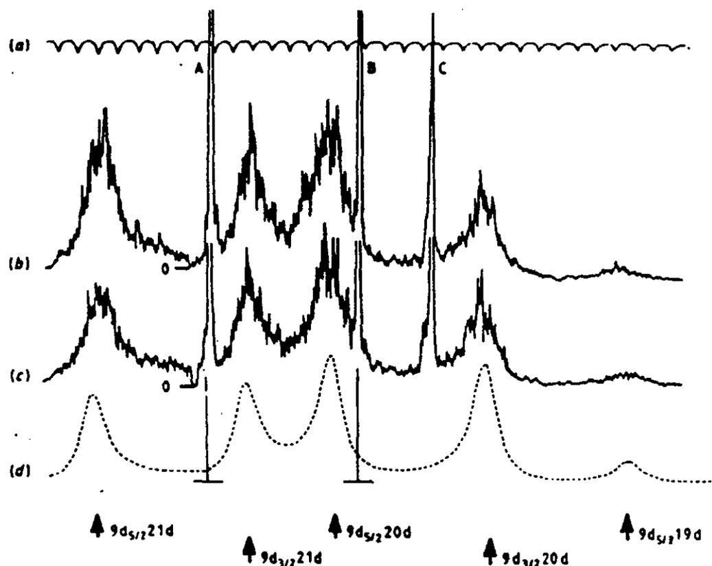
Figure II.26 : Spectre d'excitation  $6s_{1/2}19d \rightarrow 9d_j n'd$  si les faisceaux laser sont polarisés circulairement (b), linéairement (c). Franges de Fabry-Pérot ( $4 \text{ cm}^{-1}$ ) (a).
