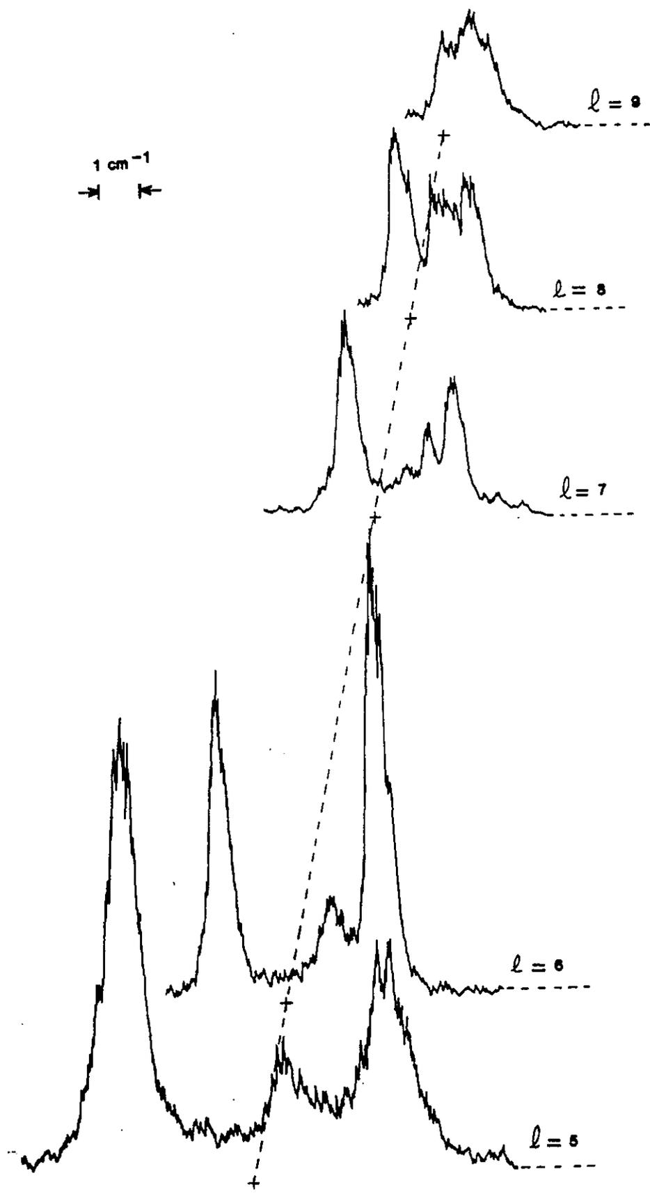
Figure IV.11 : Spectres d'excitation  $6s_{1/2}nl \rightarrow 6p_{3/2}nl$  du baryum pour  $n=11$  et  $l=5, 6, \dots, 9$ .
