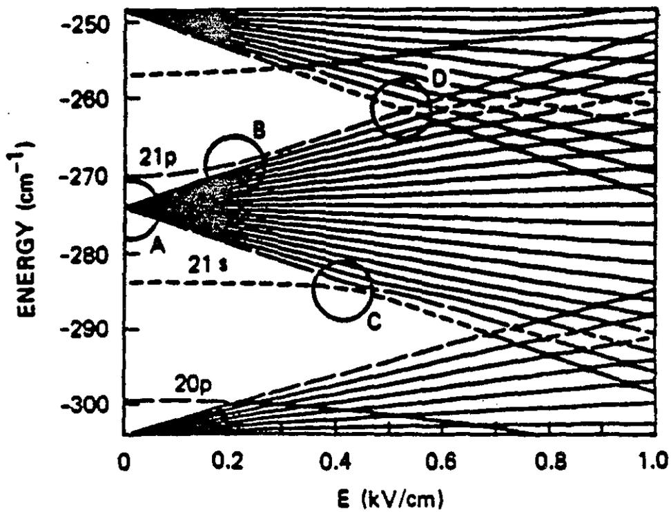
Figure III.2 : Diagramme d'énergie (tiré de la référence [8]) des niveaux  $m=0$  du sodium au voisinage de la multiplicité  $n=20$  en fonction du champ électrique. Le cercle A indique le point de champ nul où les niveaux tels que  $l>2$  se mélangent sous l'effet de la micro-onde. Les cercles B, C et D indiquent les croisements des niveaux entre les multiplicités  $n=20$  et  $n=21$ .
