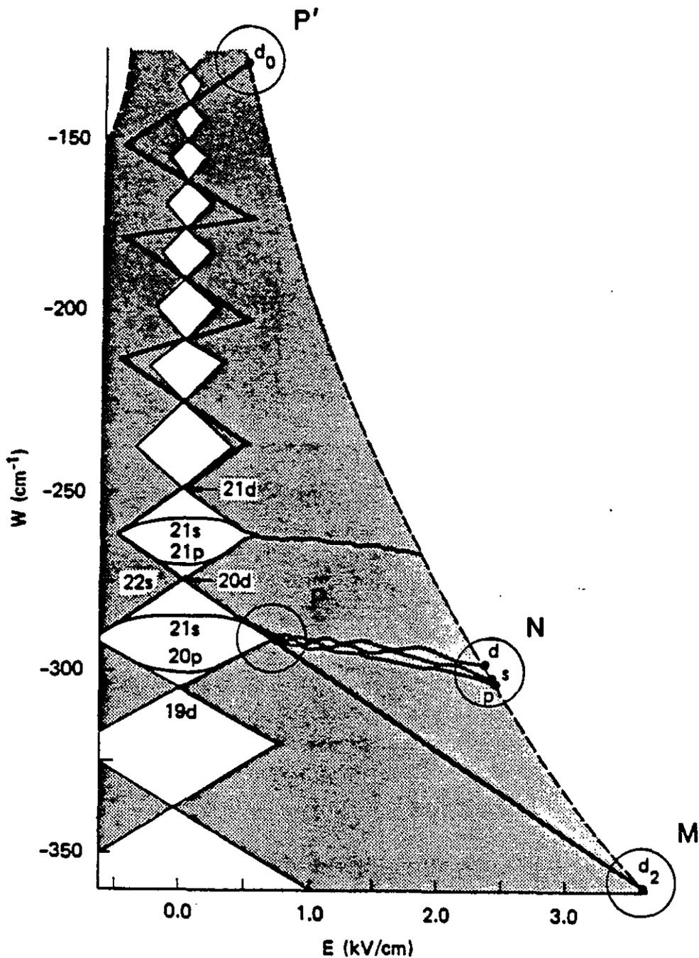
Figure III.3 : Schéma des processus d'ionisation par champ électrique et micro-onde (tiré de la référence [8]). Les parties en grisé du schéma représentent les niveaux des différentes multiplicités  $n$ . La ligne brisée entre les points P et P' correspond au processus d'ionisation avec un seuil en  $1/(3n^5)$  u.a.. La droite PM correspond au comportement diabatique avec un seuil en  $1/(9n^4)$  u.a. et les lignes PN au comportement adiabatique avec un seuil en  $1/(16n^4)$  u.a..
