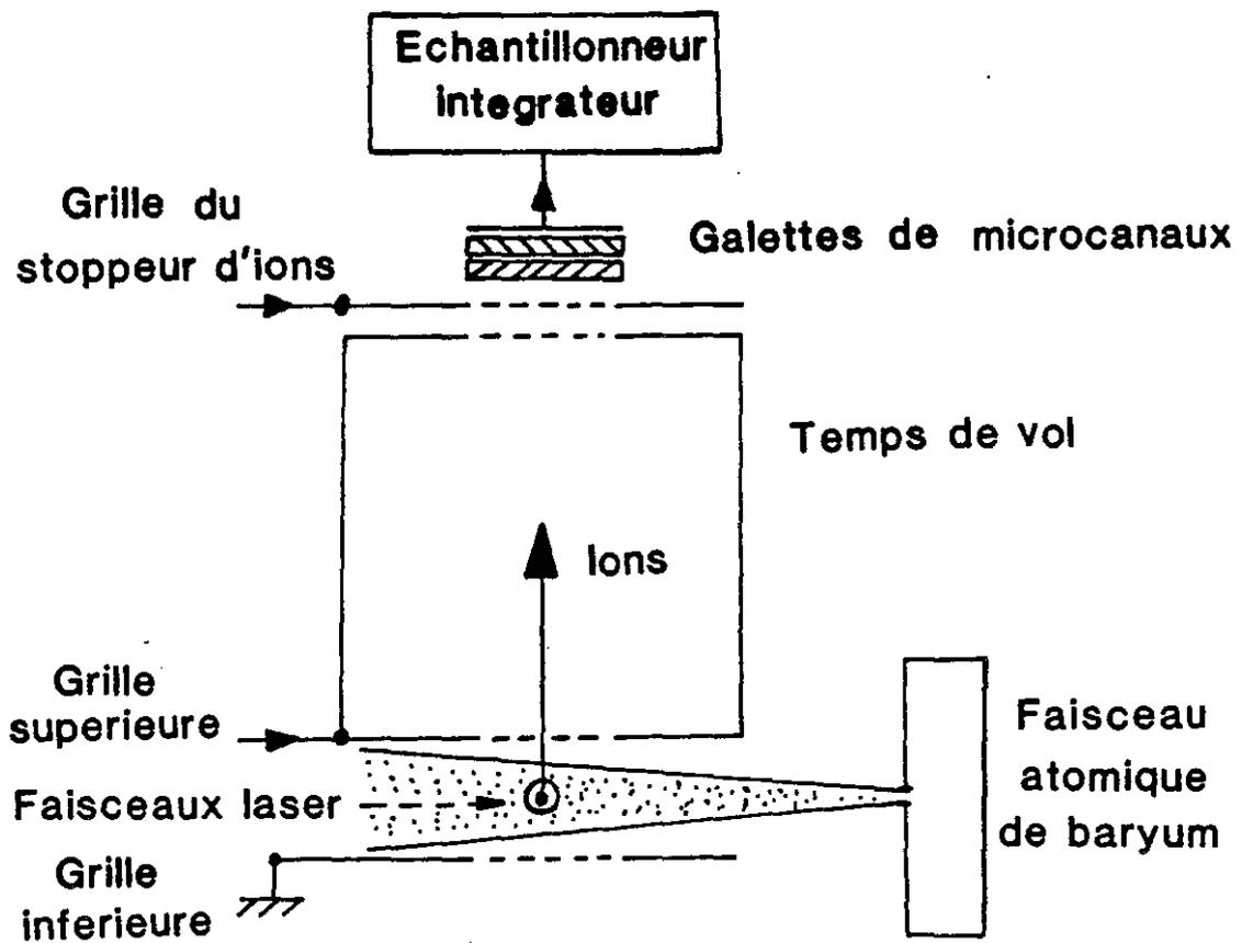
Figure II.11 : Schéma du dispositif de détection par temps de vol.
