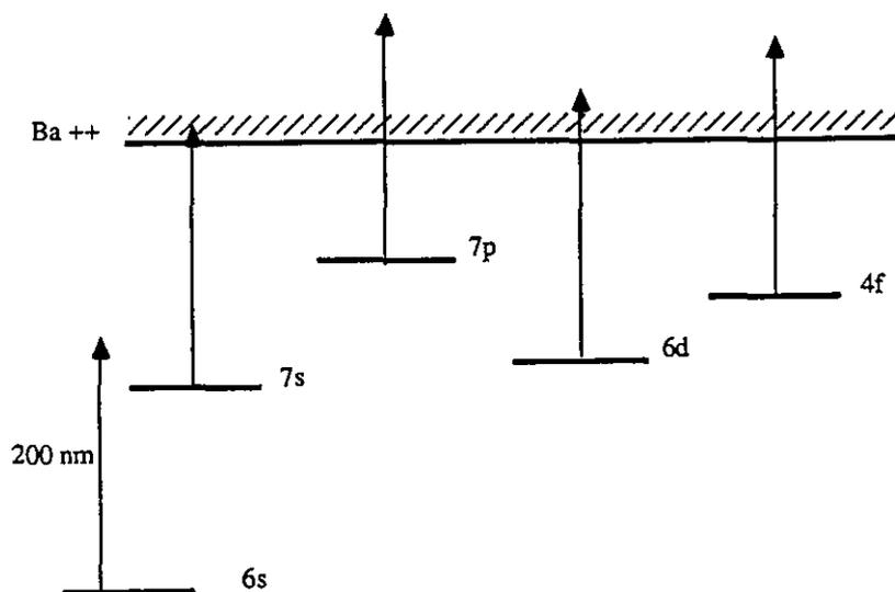
Figure II.5 : Schéma des processus de détection par photoionisation des ions Ba<sup>+</sup> excités, produits d'autoionisation
