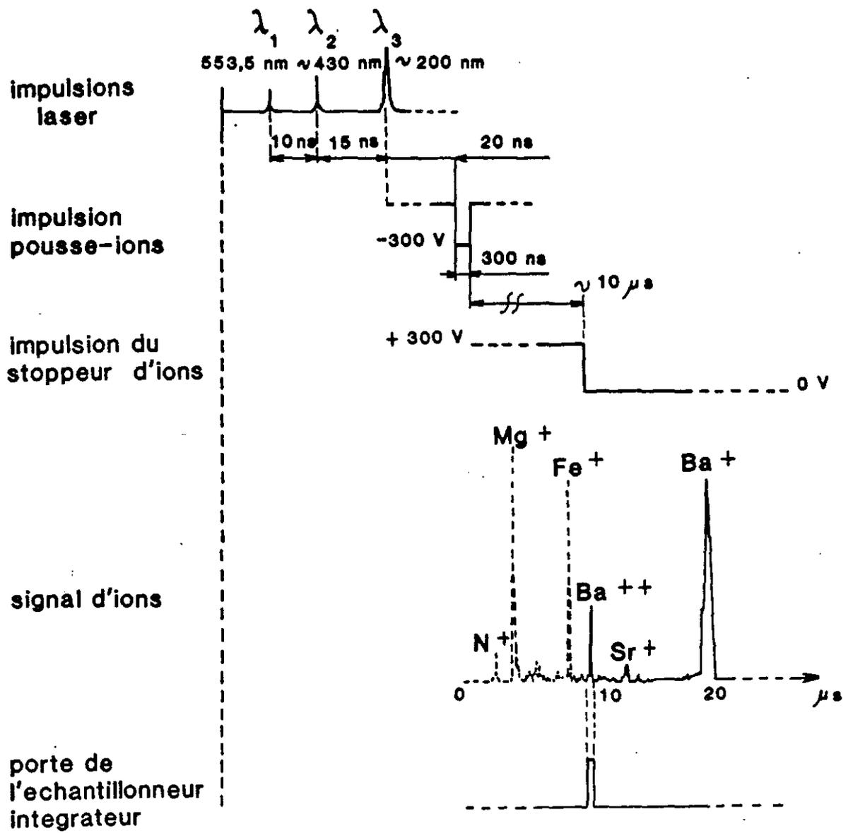
Figure II.12 : Séquence temporelle du dispositif de détection.
