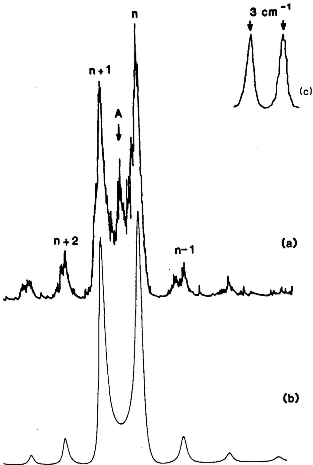
Figure II.16 : Comparaison entre le spectre expérimental correspondant à la transition  $6s42d \rightarrow 7p_{1/2}n'd$  (a) et le spectre théorique (b) calculé pour les paramètres  $\delta'=3,09$  et  $\gamma=0,17$ . Franges de Fabry-Pérot (c).
