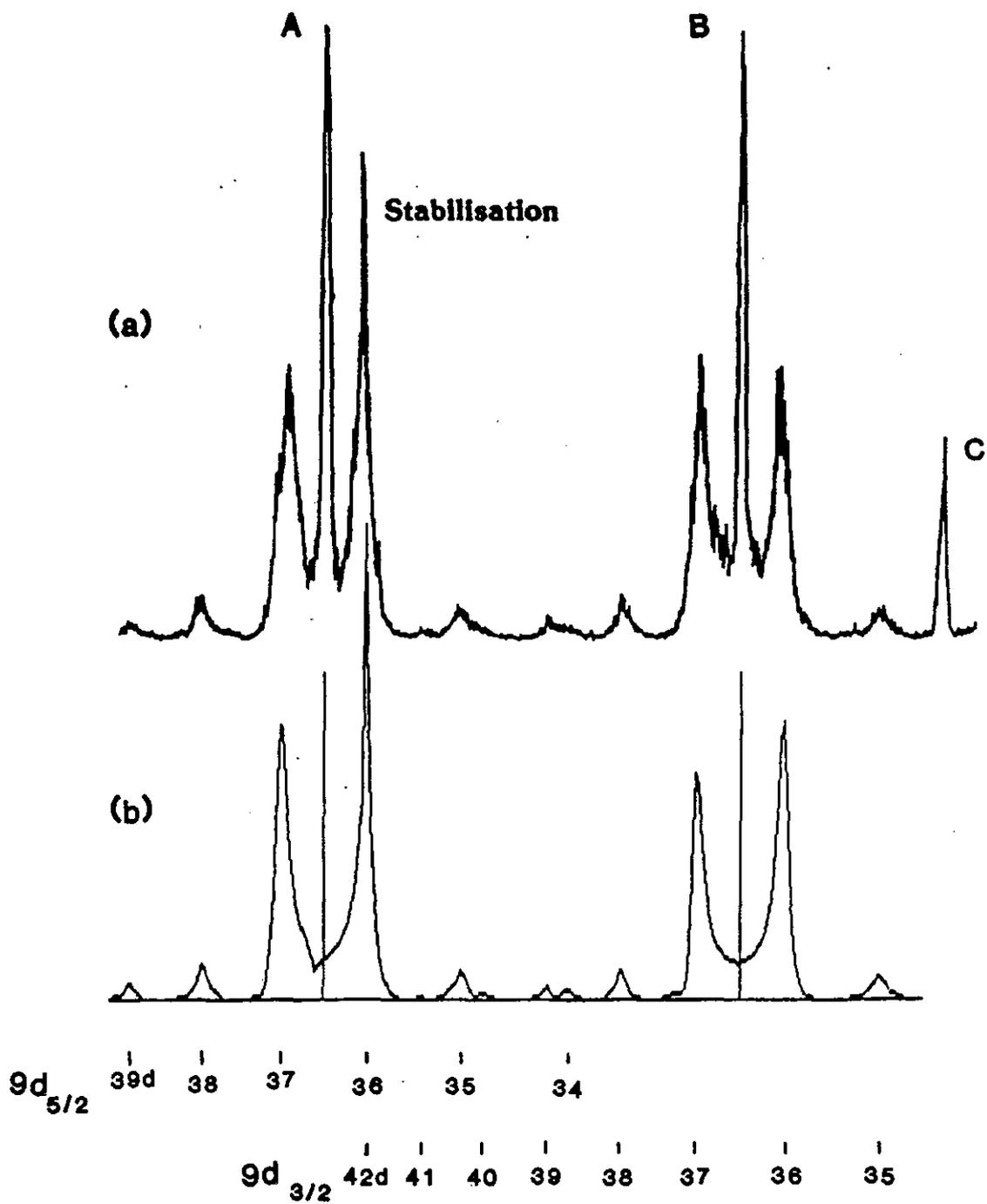
Figure II.27 : Effet de stabilisation observée (a) sur le spectre d'excitation  $6s_{1/2}35d \rightarrow 9d_{5/2}36d$  et son interprétation (b) dans un modèle à six voies.
