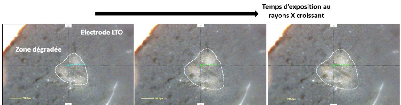
Figure 26 : Photo de la surface d'une électrode LTO présentant des dégradations au cours d'une analyse XPS.
