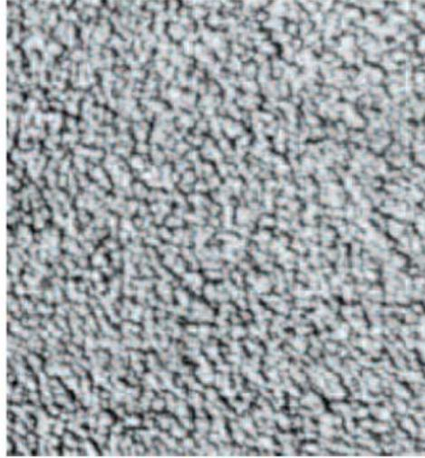
FIGURE 1.10 – Rugosité d’une pièce constatée après grenaillage [20].
