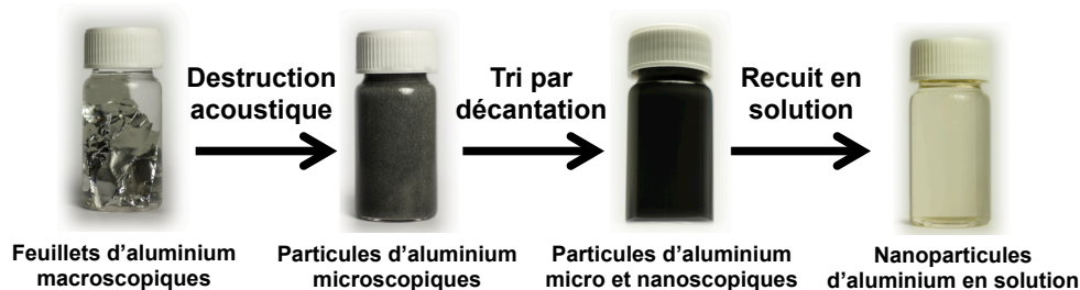
FIGURE 2.7 – Sélection de photos de piluliers à différentes étapes de la réaction. 1 : découpe de l'aluminium ; 2 : broyage de l'aluminium par cavitation ; 3 : décantation des grosses microparticules ; 4 : recuit de la solution.
