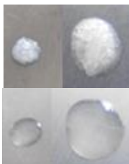
Figure 33 Gouttes de PA de 3 et 7 mm de diamètre à l'état solide (haut) et liquide (bas)
