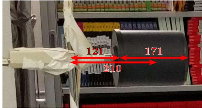
FIGURE V.6 – Photographie de la chambre d’ionisation  $1800\text{ cm}^3$  accrochée à son support présentant le décalage du centre du volume sensible de la chambre par rapport à la tige du support située à un mètre du centre du fantôme d’eau. Cotes en millimètres.
