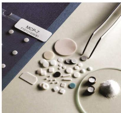
FIGURE I.37 – Illustration des différentes formes de TLD utilisées pour la dosimétrie.
