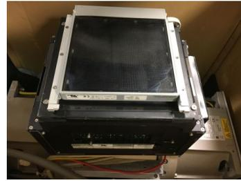
(b) Chambre à transmission montée sur le dispositif de collimation d'une machine Philips Allura.
