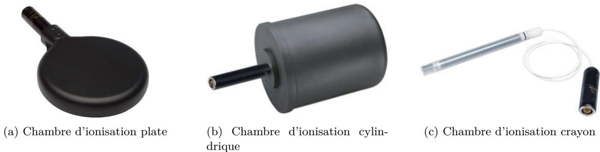
FIGURE I.33 – Exemples de chambre d’ionisation utilisées en radiologie [51].
