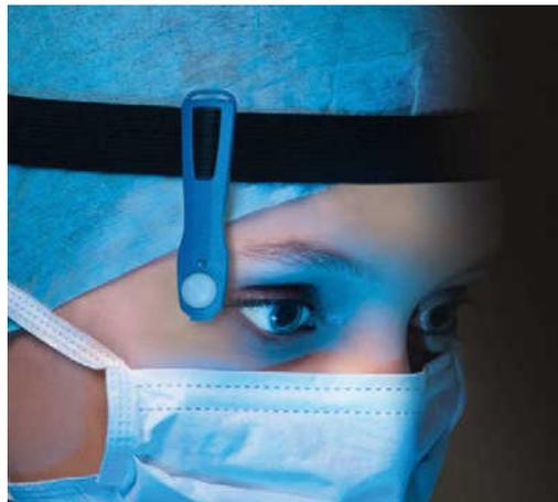
FIGURE A.7 – Illustration du dosimètre cristallin EYE-D [251].
