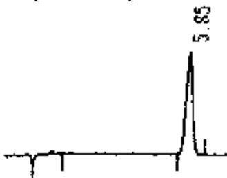
Schéma 2.4. Chromatogramme type d'analyse des sulfates par chromatographie ionique (solution de 20 ppm, éluant = solution aqueuse du  $\text{Na}_2\text{CO}_3$  et du  $\text{NaHCO}_3$  en concentration de  $1.8 \cdot 10^{-3}$  M chacun, régénérant = acide sulfurique à 0.013 M, débit d'éluant = 2 ml/m).
