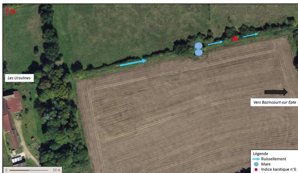
Figure 148 : Situation des mares et du point d'infiltration (indice karstique) n'ayant pas fait l'objet de traçage projeté sur vue aérienne
