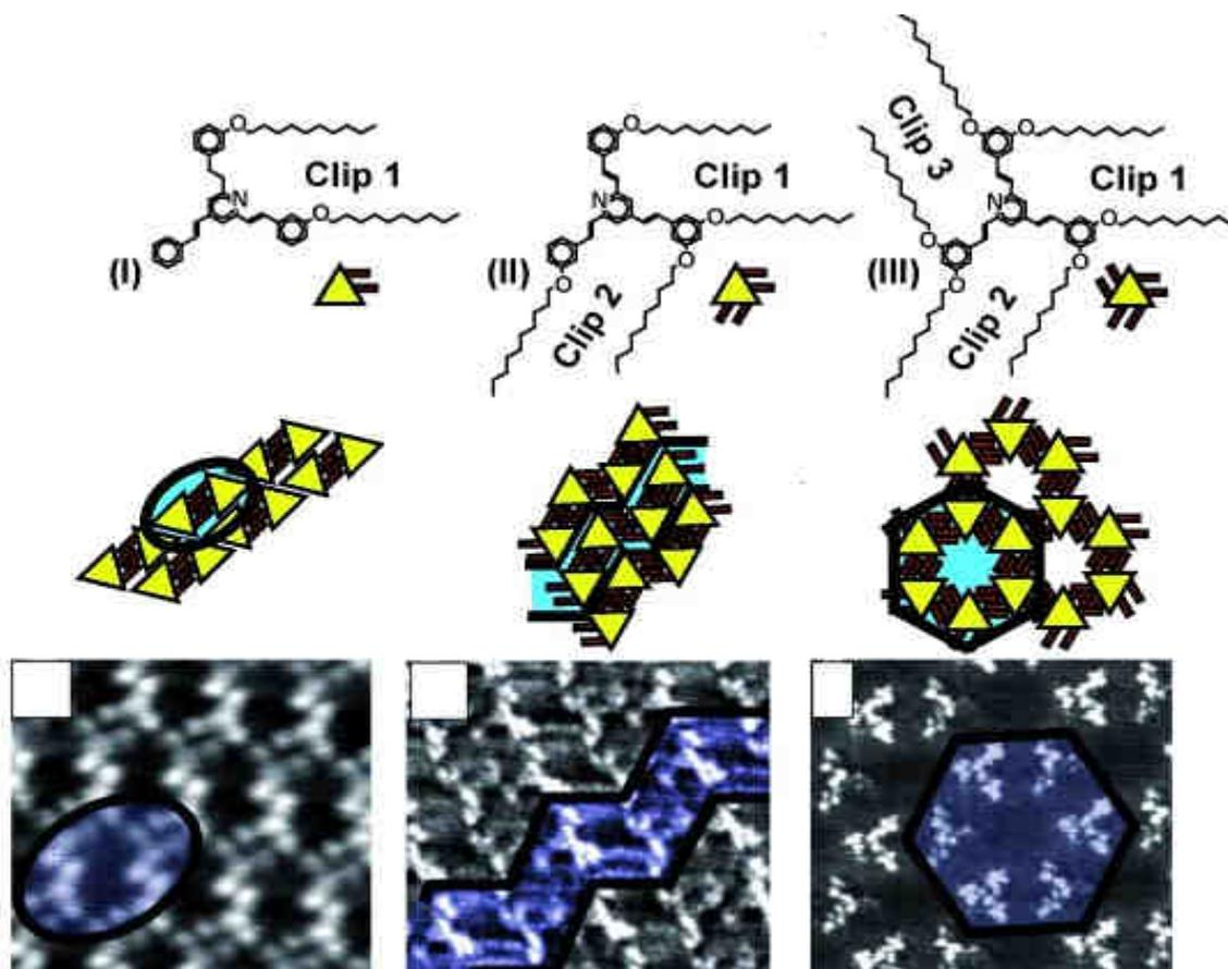
Figure 27 : Images STM montrant le rôle du clip dans l'auto-assemblage sur surface. Images STM réalisées à l'interface phényloctane/HOPG à température ambiante ( $I_t = 15 \text{ pA}$  ;  $V_t = -1,0 \text{ V}$ ).
