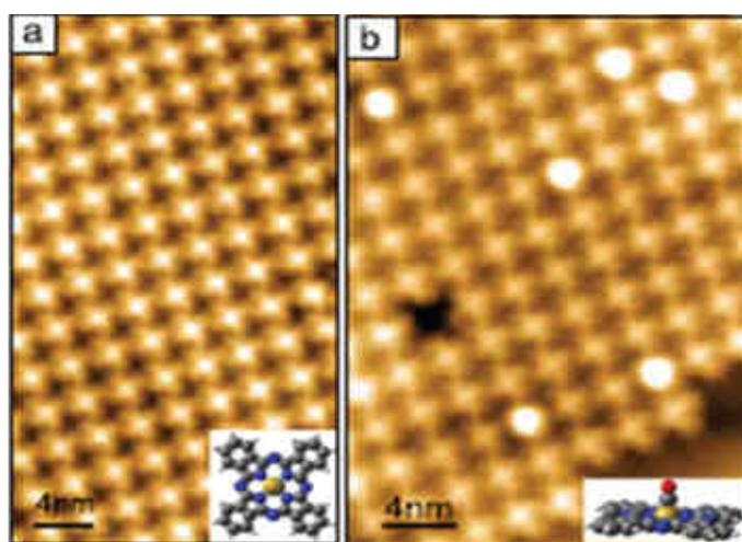
**Figure 37 :** a) Image STM d'un îlot MnPc hautement ordonné (5K,  $V_t = 0,25$  V,  $I_t = 0,2$  nA). b) MnPc après exposition au CO (5K,  $V_t = 0,18$  V,  $I_t = 0,2$  nA).
