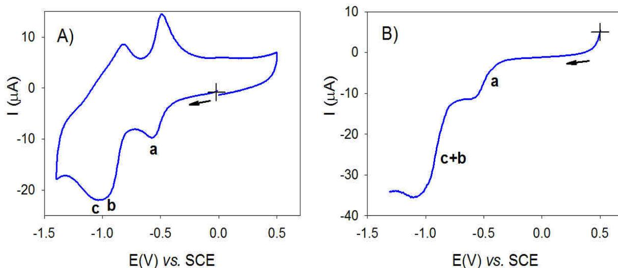
Figure 54 : A) Voltampérométrie cyclique du composé  $81Cl_4$  dans  $H_2O$  ( $10^{-4}$  M) en présence de KCl à 0,1 M avec une électrode de travail en carbone vitreux, vitesse de balayage  $100\text{ mV}\cdot\text{S}^{-1}$ ,  $d = 3\text{ mm}$  ; B) Voltampérométrie stationnaire du composé  $81Cl_4$  dans  $H_2O$  ( $10^{-4}$  M) en présence de KCl à 0,1 M avec une électrode de travail en carbone vitreux,  $v = 20\text{ mV}\cdot\text{S}^{-1}$ , 1000 rpm.
