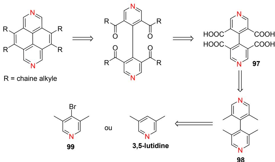
Figure 58 : Rétrosynthèse de 2,7-diazapyrène substitué.
