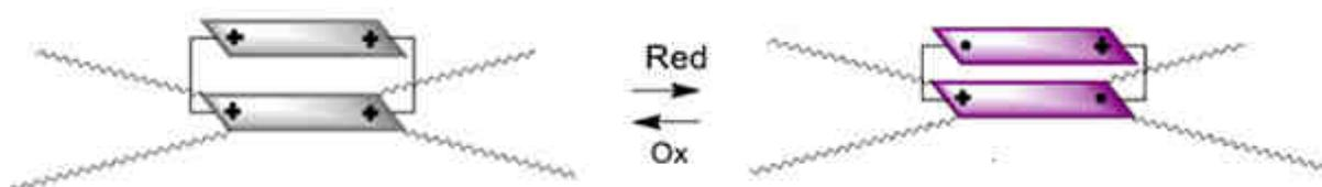
Figure 44 : Principe d'induction redox pour un cyclophane isolé. Le cas intermédiaire dans lequel un  $\pi$ -mère ( $2^+$ )/( $^{+*}$ ) est formé n'est pas représenté.
