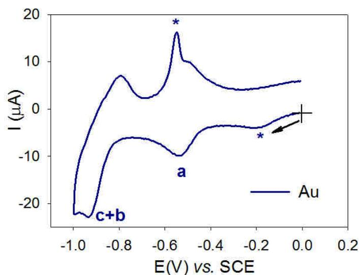
Figure 55 : Voltampérométrie cyclique du composé  $81Cl_4$  dans  $H_2O$  ( $10^{-4}$  M) en présence de KCl à 0,1 M avec une électrode de travail en or, vitesse de balayage =  $100\text{ mV}\cdot\text{S}^{-1}$ ,  $d = 3\text{ mm}$ , \* : pic de désorption.
