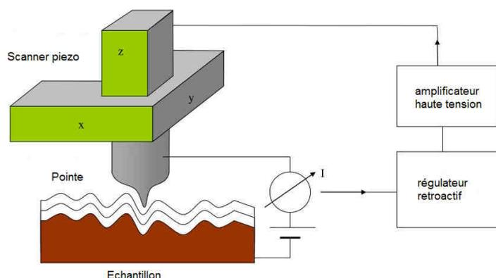
Figure 23 : Schéma d'un microscope à effet tunnel.<sup>100</sup>
