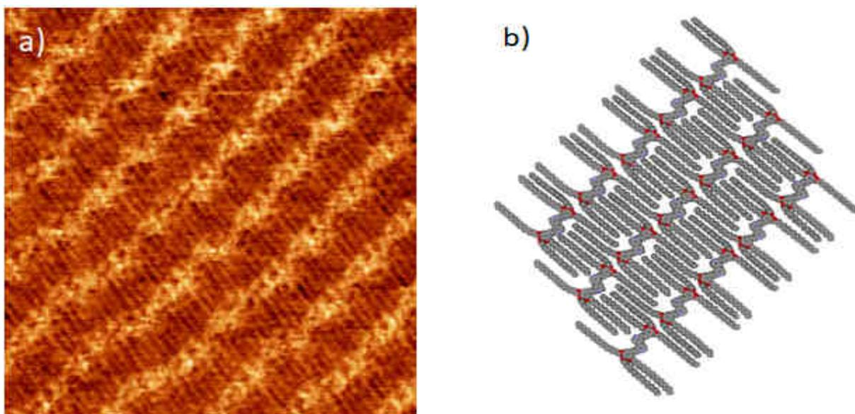
Figure 51 : a) Image STM de la monocouche de la bipyridine **71** physisorbée à l'interface liquide/HOPG. Paramètres :  $I_t = 20 \text{ nA}$ ,  $V_t = 200 \text{ mV}$ . b) Modèle moléculaire de l'auto-organisation.
