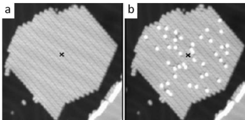
**Figure 35 :** a) Ilot contenant environ 400 molécules de trans, les impulsions de tensions ((20 s,  $V_{\text{pointe}} = 2 \text{ V}$ , hauteur de pointe = 6 Å) sont appliquées à la position indiquée par la croix. (b) Image STM après neuf impulsions : 43 molécules trans ont été modifiées en forme cis.
