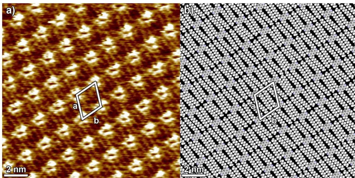
Figure 47 : a) Image STM de la monocouche de la bipyridine **52** physisorbée à l'interface liquide/HOPG. Paramètres :  $I_t = 20 - 25 \text{ pA}$ ,  $V_t = -400 \text{ --} -600 \text{ mV}$ . b) Modèle moléculaire de auto-organisation. Les paramètres de la cellule sont donnés par  $a = 2,1 \pm 0,1 \text{ nm}$ ,  $b = 1,8 \pm 0,1 \text{ nm}$ ,  $\alpha = (66 \pm 2)^\circ$  conduisant à une surface de  $3,45 \pm 0,1 \text{ nm}^2$ .
