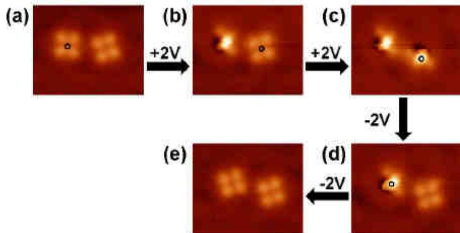
**Figure 41 : Séquence d'images STM montrant la commutation réversible de deux molécules. La position de la pointe au-dessus de la molécule lors de l'application de la tension de polarisation est marquée par un cercle noir.<sup>120</sup>**
