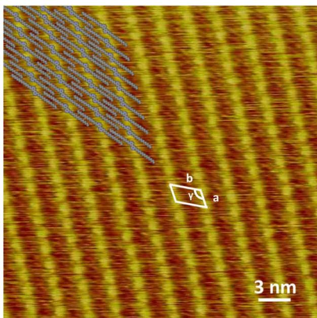
Figure 52 : Image STM de la monocouche de la bipyridine **72** physisorbée à l'interface liquide/HOPG. Paramètres :  $I_t = 70 \text{ pA}$ ,  $V_t = -800 \text{ mV}$ . (En haut à gauche) Modèle moléculaire de l'auto-organisation. Les paramètres de la cellule sont donnés par  $a = 1,45 \pm 0,1 \text{ nm}$  ;  $b = 2,99 \pm 0,1 \text{ nm}$  ;  $\gamma = (42 \pm 2)^\circ$ .
