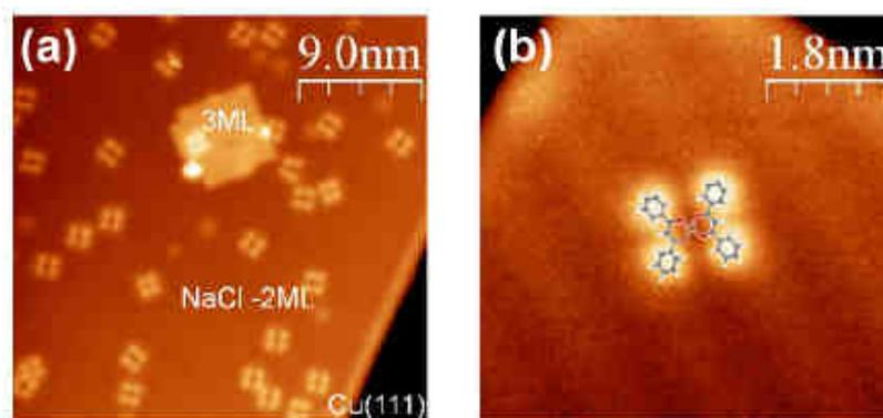
Figure 40 : Images STM de  $[\text{Cu}(\text{dbm})_2]$  sur une bicouche de NaCl sur Cu(111) à 5 K. a) courant de tunnel  $I_t = 1 \text{ pA}$ , tension de bias  $V_t = 1 \text{ V}$ . (b)  $I_t = 700 \text{ fA}$ ,  $V_t = 1,2 \text{ V}$ .<sup>120</sup>
