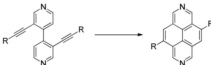
**Schéma 34 : Synthèse de 2,7-diazapyrène substitué à partir de bipyridine substituée en position 3 et 3' par des alcynes.**
