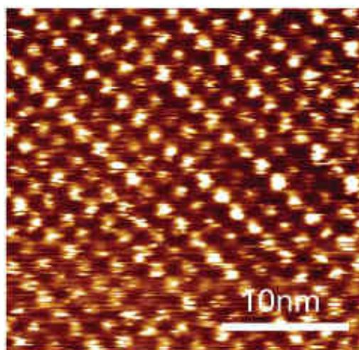
Figure 28 : Image STM à l'interface solution/HOPG exposant un empilement hexagonal (à température ambiante,  $V_t = -1.4$  V,  $I_t = 50$  pA).<sup>107</sup>
