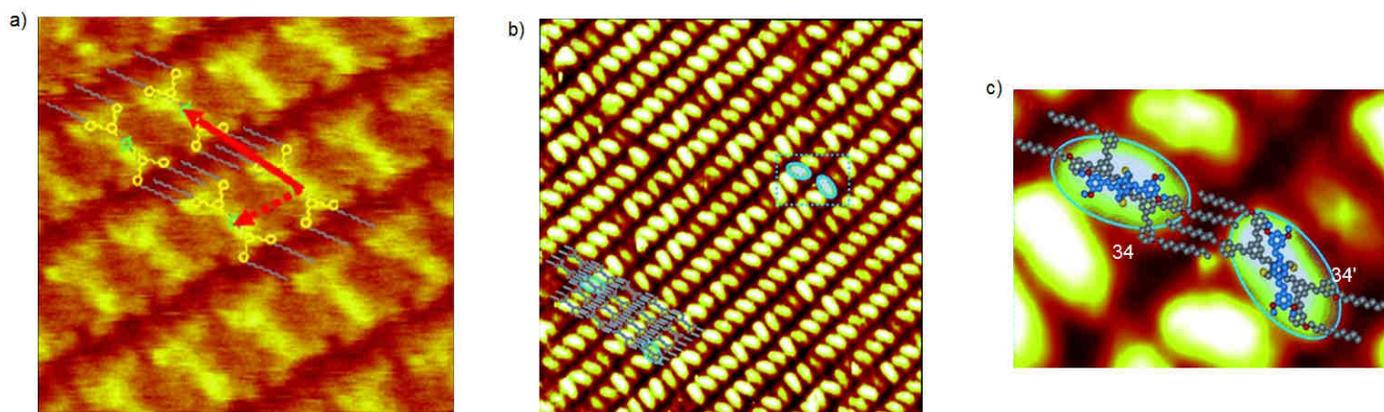
Figure 31 : a) Image STM du piédestal seul à l'interface phényloctane/HOPG, courant de tunnel  $I_t = 55$  pA, tension de bias et  $V_t = -1,55$  V, taille du scan  $12,5$  nm<sup>2</sup> ; b) Image STM de la molécule **34** et **34'**  $V_t = -1,56$  V et  $I_t = 27,0$  pA, taille du scan  $49,3$  nm<sup>2</sup> ; zoom de l'image STM de la molécule **34** et **34'**.
