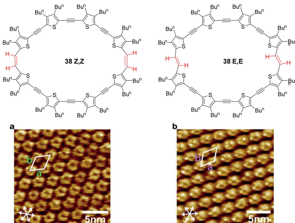
Figure 36 : Images STM a) **38 Z,Z** :  $a = (2,81 \pm 0,04)$  nm,  $b = (2,78 \pm 0,03)$  nm ( $V_t = -1.14$  V et  $I_t = 95$  pA) ; b)  $a = (2,92 \pm 0,03)$  nm  $b = (2,89 \pm 0,02)$  nm ( $V_t = -0.77$  V et  $I_t = 100$  pA).
