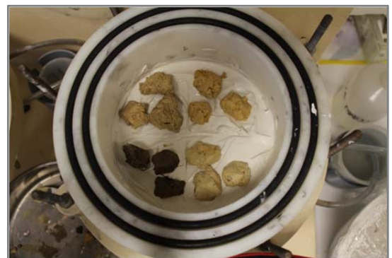
Figure 9- 13 Mise en place des a) échantillons cylindriques et b) mottes dans la presse de Richards avant la fermeture de l'enceinte.
