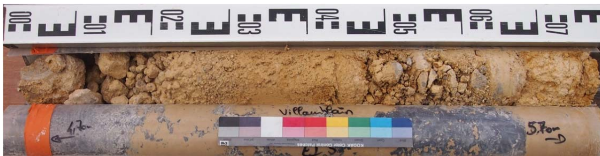
Sondage carotté 1 – échantillon intact 5 (SC1-EI4) : 4,7 à 5,7 m
