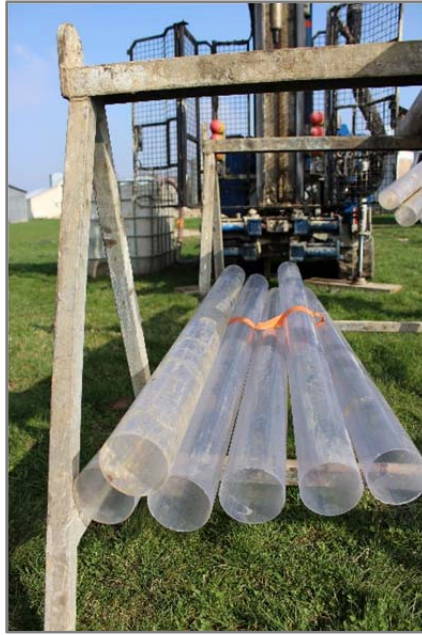
Figure 10- 5 Gains transparentes pour le carottage à l'eau avec le carottier triple.
