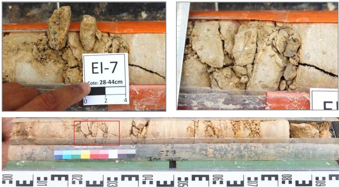
Figure 13- 7 Echantillonnage pour la diffractométrie X sur lame orientée (7,28-7,44 m-SC2).
