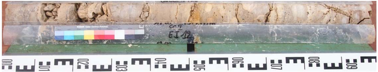
Sondage carotté 2 – échantillon intact 12 (SC2-EI12) : 12 à 13 m
