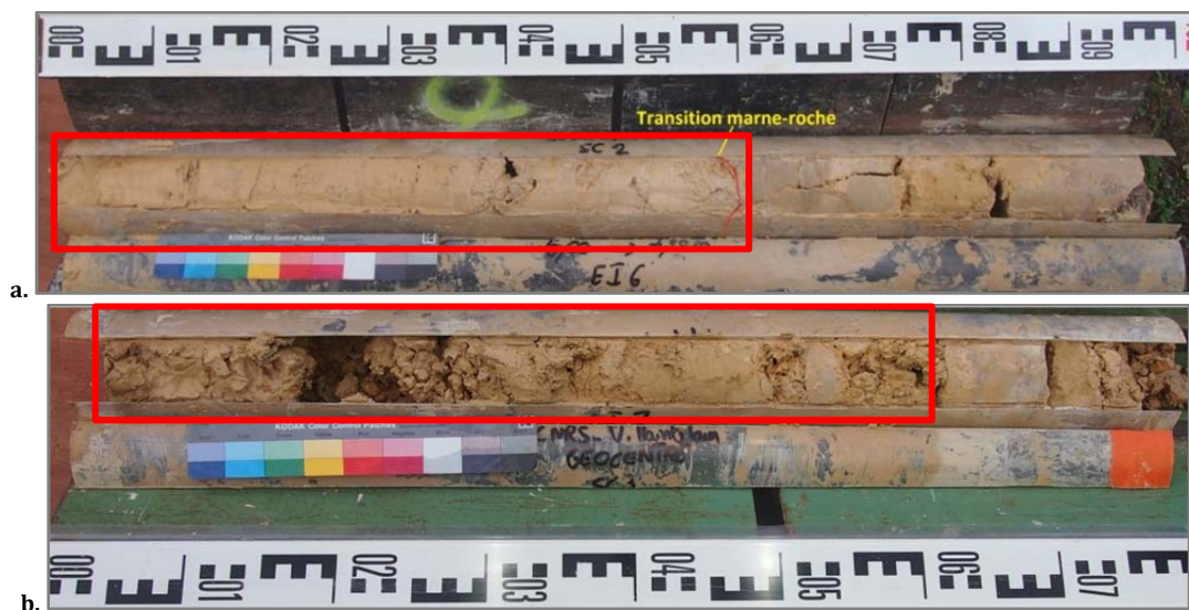
Figure 11- 7 a) Couche de marne avec texture limoneuse fine (rectangle rouge) observé dans SC 2 entre 6 et 6,6 m de profondeur, b) couche de marne avec texture limoneuse fine (rectangle rouge) observé dans le SC 3 entre 6 et 6,6 m de profondeur.
