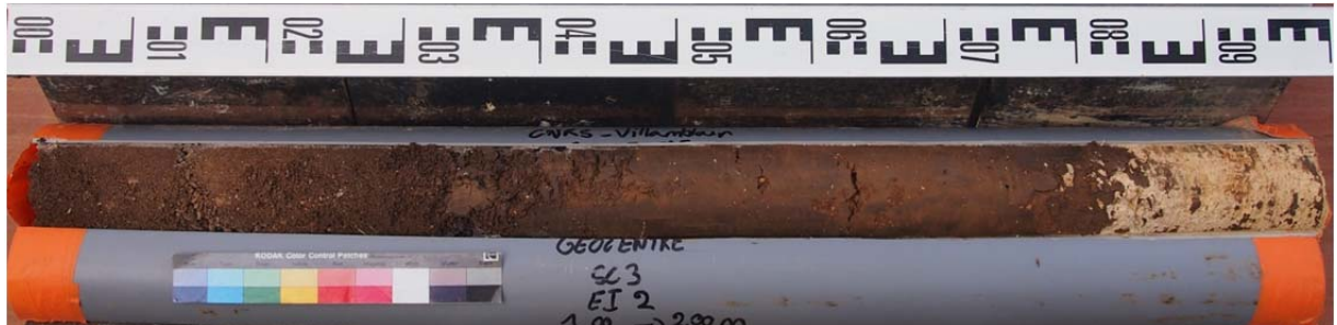
Sondage carotté 3 – échantillon intact 2 (SC3-EI2) : 1 à 2 m
