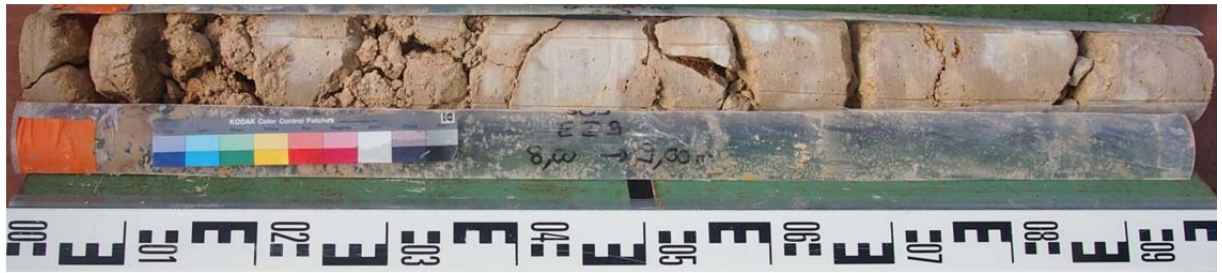
Sondage carotté 3 – échantillon intact 9 (SC3-EI9) : 8 à 9 m
