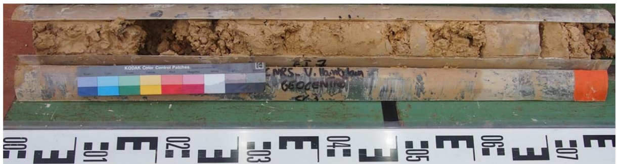
Sondage carotté 3 – échantillon intact 7 (SC3-EI7) : 6 à 7 m
