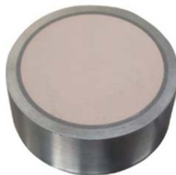
Figure 7- 2 Piédestal avec céramique poreuse HEA.
