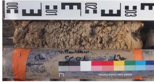
Figure 11- 11 Carotte 6 (EI-6) du sondage SC1 prélevé entre 5,7 m et 6,1 m de profondeur.
