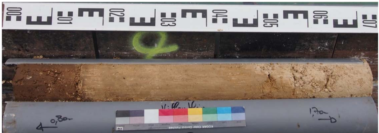
Sondage carotté 1 – échantillon intact 2 (SC1-EI2) : 0,8 à 1,7 m
