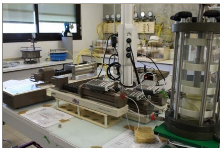
Figure 7- 4 Le système triaxial non conventionnel utilisé pour la mesure des propriétés hydriques des matériaux de la ZNS.
