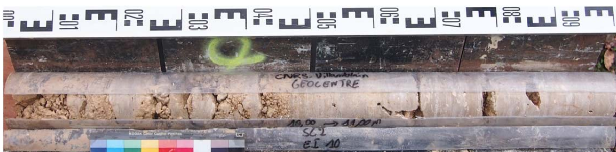
Sondage carotté 2 – échantillon intact 10 (SC2-EI10) : 10 à 11 m
