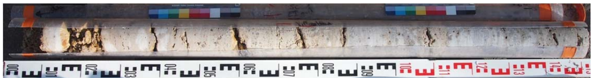
Sondage carotté 1 – échantillon intact 12 (SC1-EI12) : 13,3 à 14,9 m
