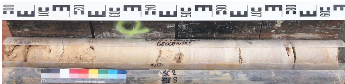
Sondage carotté 2 – échantillon intact 8 (SC2-EI8) : 8 à 9 m
