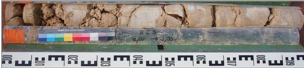
Figure 11- 16 Calcaire micritique grisâtre très fracturé. EI-9 du SC3 (8 à 9 m).
