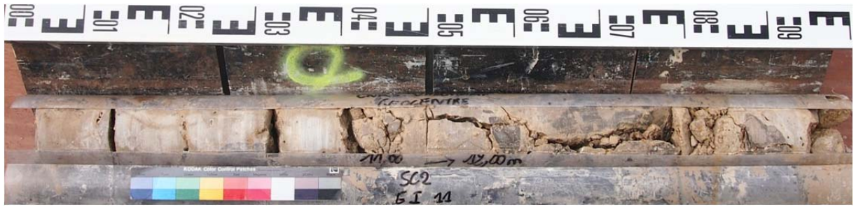
Sondage carotté 2 – échantillon intact 11 (SC2-EI11) : 11 à 12 m
