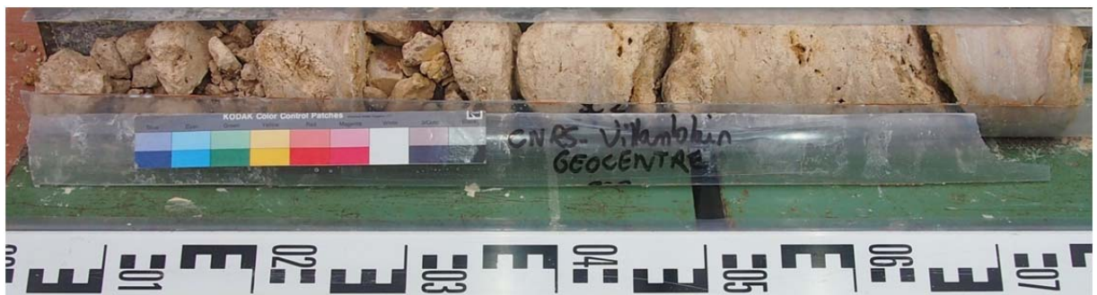
Sondage carotté 2 – échantillon intact 18 (SC2-EI18) : 18 à 19 m
