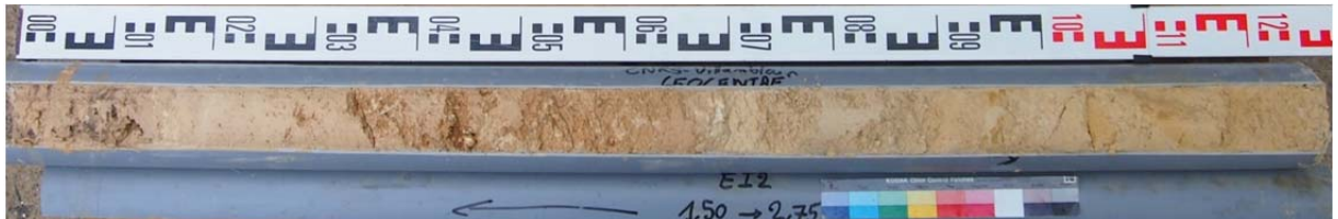
Sondage carotté 2 – échantillon intact 2 (SC2-EI2) : 1,5 à 2,75 m
