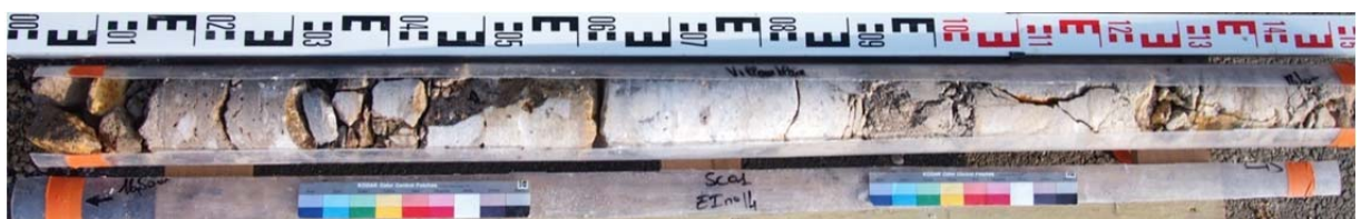
Sondage carotté 1 – échantillon intact 14 (SC1-EI14) : 16,5 à 18,1
