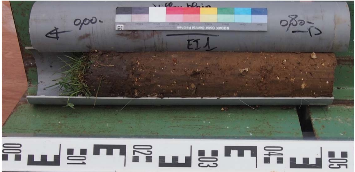
Sondage carotté 1 – échantillon intact 1 (SC1-EI1) : 0 à 0,8 m
