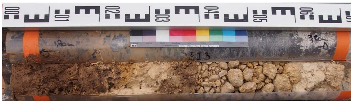
Sondage carotté 1 – échantillon intact 3 (SC1-EI3) : 1,7 à 3,2 m
