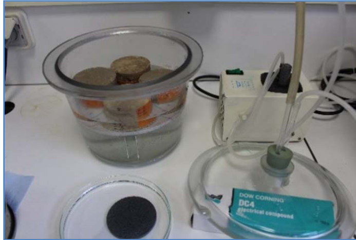
Figure 8- 9 Saturation par capillarité des échantillons de roches calcaires dures.
