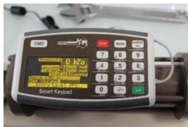
Figure 7- 6 Clavier à membrane pour le pilotage manuel d'un CPV.
