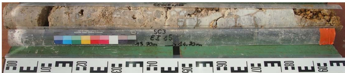
Sondage carotté 3 – échantillon intact 15 (SC3-EI15) : 13,7 à 14,7 m
