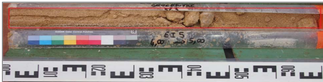
Figure 11- 10 Couche sableuse (rectangle rouge) du SC3 prélevé entre 4 m et 4,7 m de profondeur.
