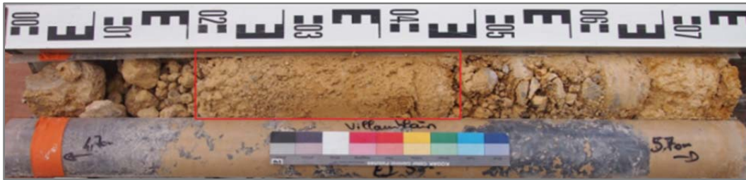
Figure 11- 8 Couche sablo-marneuse (rectangle rouge) du SC1 prélevé entre 4,7 m et 5,5 m de profondeur
