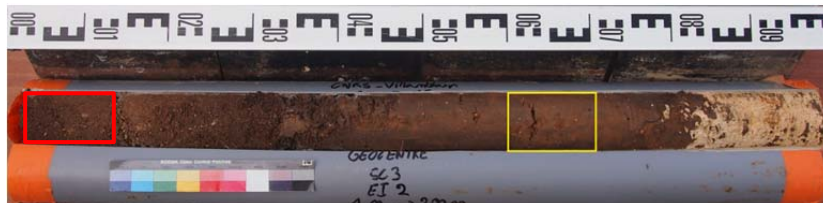
Figure 12- 13 Prélèvement d'un échantillon de sol (rectangle jaune) pour un analyse de surface spécifique de grains (1,4-1,5 m-SC3).
