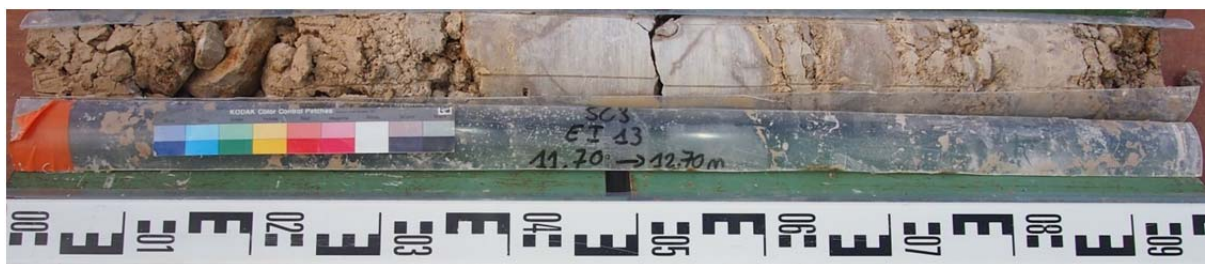
Sondage carotté 3 – échantillon intact 13 (SC3-EI13) : 11,7 à 12,7 m
