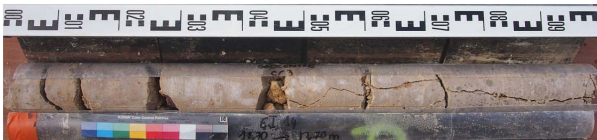
Sondage carotté 3 – échantillon intact 14 (SC3-EI14) : 12,7 à 13,7 m
