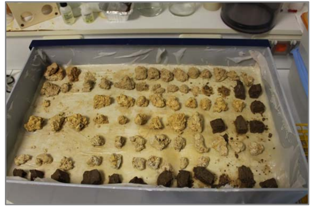
Figure 9- 12 a) Saturation des échantillons cylindriques sous vide dans un cristalliseur, b) saturation des mottes avec un bac à sable.
