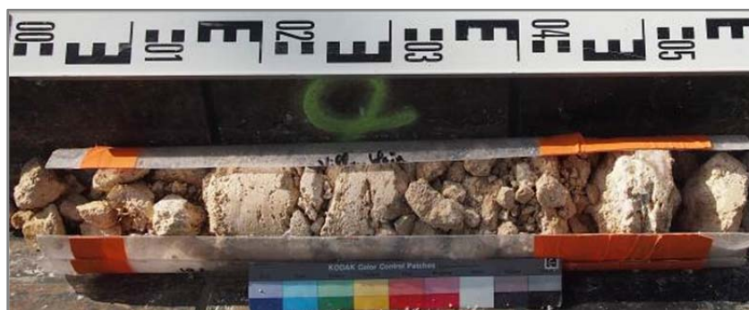
Figure 11- 31 EI-16 du SC1 (19,2 à 19,8 m). Calcaire blanchâtre fracturé avec zones dissolution et déstructuration.
