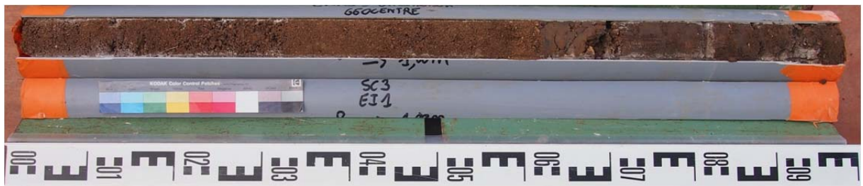
Sondage carotté 3 – échantillon intact 1 (SC3-EI1) : 0 à 1 m
