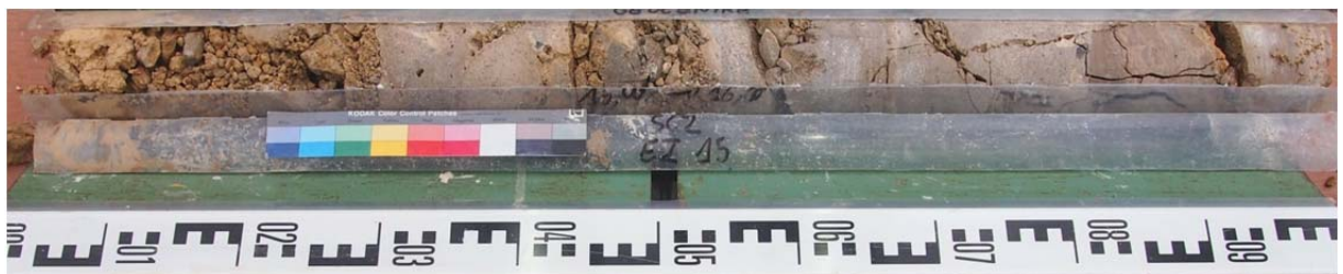
Sondage carotté 2 – échantillon intact 15 (SC2-EI15) : 15 à 16 m
