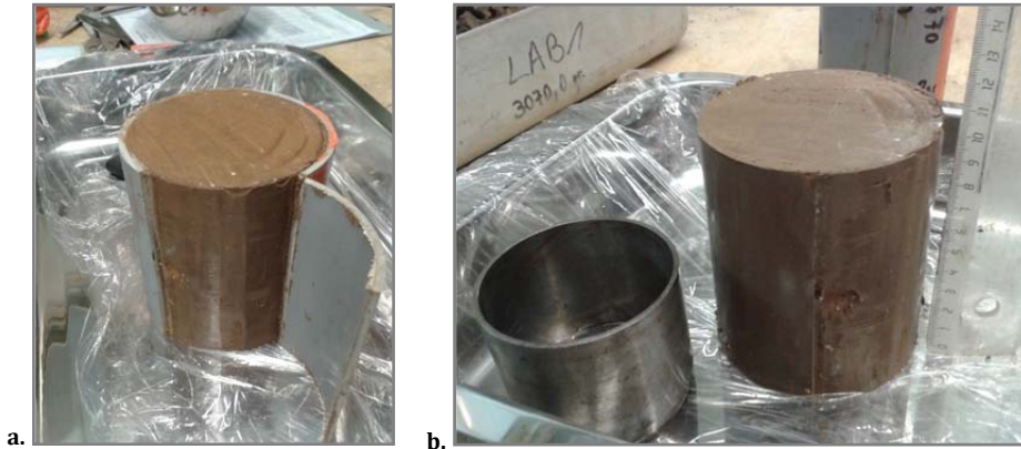
Figure 10- 9 a) Carotte sous gaine de 96 mm de diamètre et 100 cm de hauteur, b) Carotte sans gaine prête pour le prélèvement de l'éprouvette avec la trousse coupante en 70 mm.
