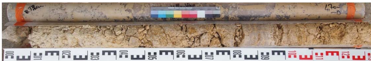
Sondage carotté 1 – échantillon intact 4 (SC1-EI4) : 3,2 à 4,7 m
