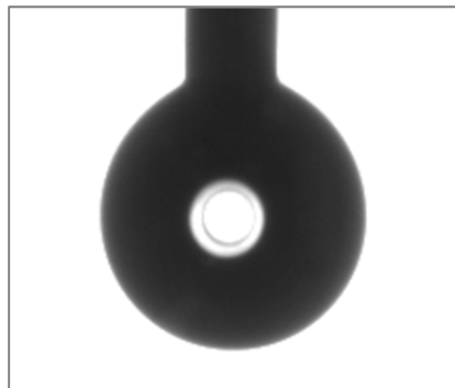
Figure 14- 2 Vue de la goutte de solution aqueuse utilisée pour la mesure de tension de surface (grossissement x20)
