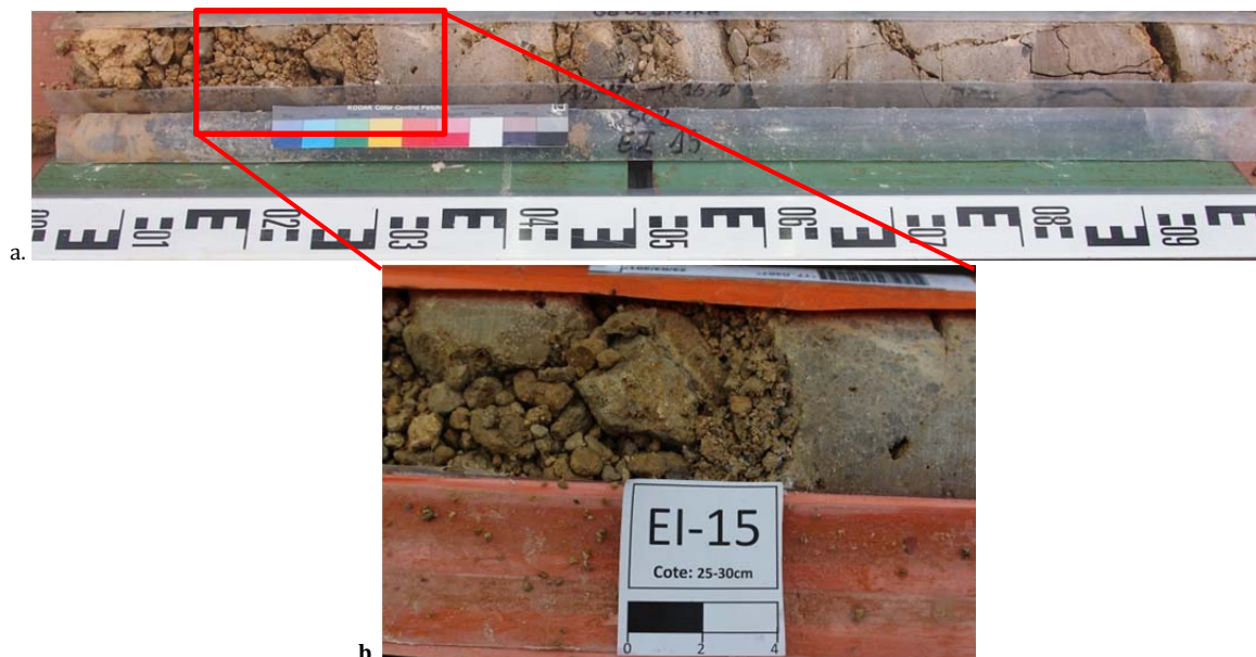
Figure 11- 23 a) EI-15 du SC2 (15 à 16 m) et b) graves de granulométrie hétérogène à 15,2 m de profondeur.
